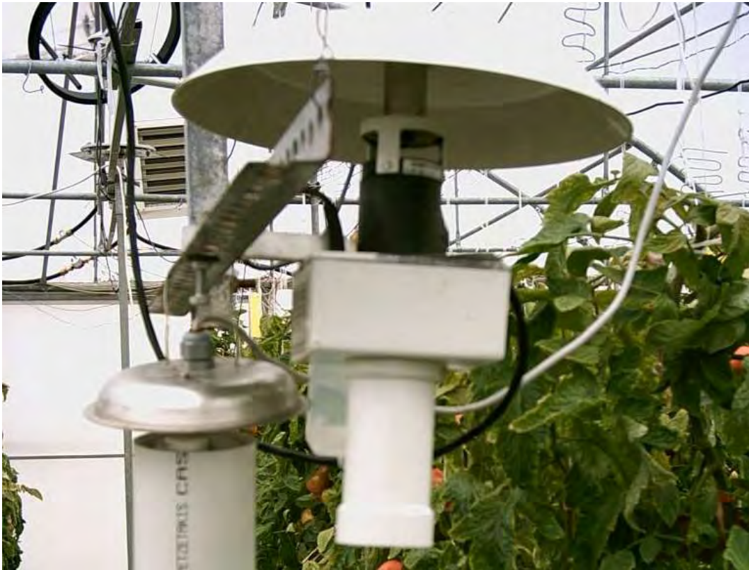
Εικόνα 6. Ψυχρόμετρο που χρησιμοποιήθηκε κατά τη διάρκεια του πειράματος.
