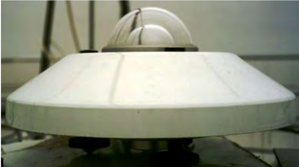
Εικόνα 7. Πυρανόμετρο που χρησιμοποιήθηκε κατά τη διάρκεια του πειράματος.
