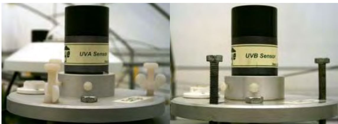
Εικόνα 8. Αισθητήρες UVA και UVB που χρησιμοποιήθηκαν κατά τη διάρκεια του πειράματος.
