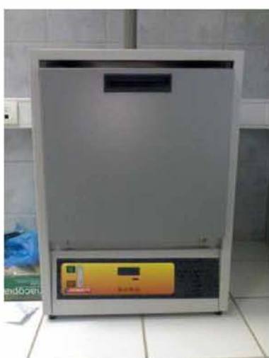
Εικόνα 2.8δ: κλίβανος αποτέφρωσης (Carbolite) κλειστός
