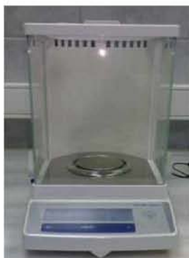
Εικόνα 2.5α: Ζυγαριά ακριβείας (Mettler Toledo AB204-S/fact)
