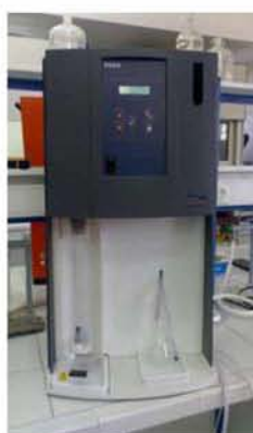
Εικόνα 2.6β: Μηχάνημα μέτρησης ολικού αζώτου (Foss Tecator 2200)
