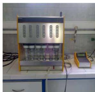
Εικόνα 2.5γ: Μηχάνημα μέτρησης ολικού λίπους (Gerhard 416)
