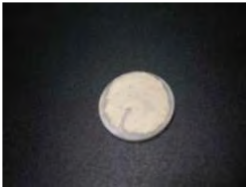
Εικόνα 5.5: Ηλεκτρόδιο εργασίας πελλέτας μετά από αναγωγή.
