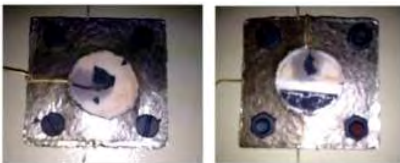
Εικόνα 6.1: Πελλέτα YSZ με αποκόλληση σιδήρου.
