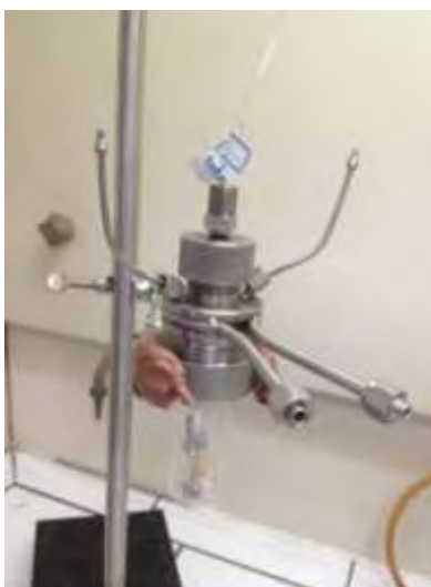
Εικόνα 5.3: Αντιδραστήρας μονού θαλάμου μικρότερου όγκου. Μακρινή λήψη.
