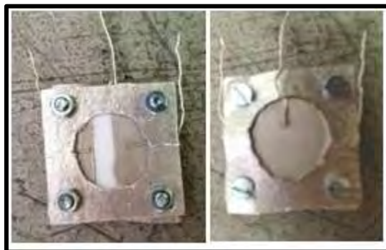
Εικόνα 3.4: Βάση στήριξης της βαμμένης με μεταλλικό καταλύτη πελλέτας από αδρανές υλικό μίκας
