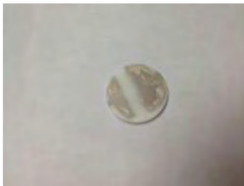
Εικόνα 5.6: Ηλεκτρόδια μέτρησης (μεγάλο) και αναφοράς (μικρό) πελλέτας μετά από αναγωγή.
