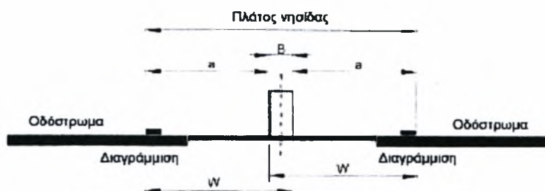
Αμφίπλευρο στηθαίο ασφαλείας που τοποθετείται στο μέσον της νησίδας ΣΧΗΜΑ 17Α
