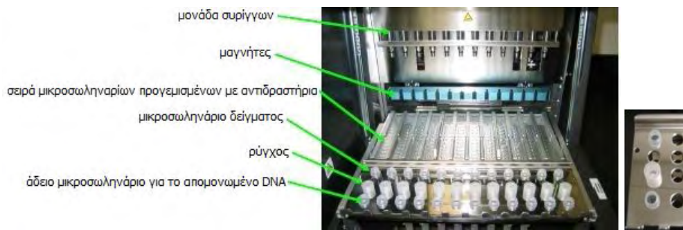
Εικόνα 2. Τοποθέτηση σε προβλεπόμενες θέσεις του συστήματος Magtation.
