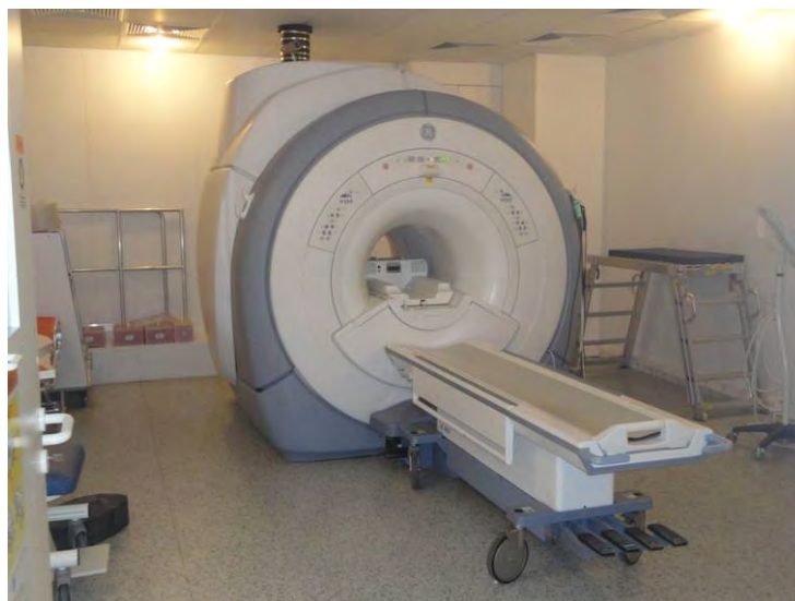
Εικόνα 5.1.1 Σύστημα Μαγνητικής Τομογραφίας υψηλού πεδίου 3T εγκατεστημένο στο Πανεπιστημιακό Γενικό Νοσοκομείο Λάρισας.
