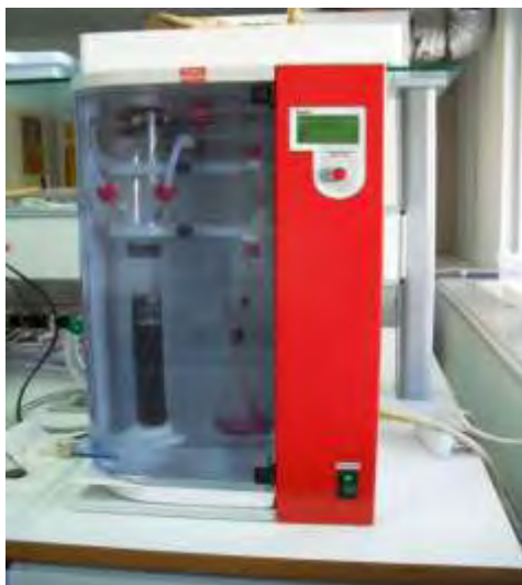
Εικόνα 16: Συσκευή απόταξης (Steam Distillation Apparatus S4 της Behr, φωτογραφία συγγραφέα).
