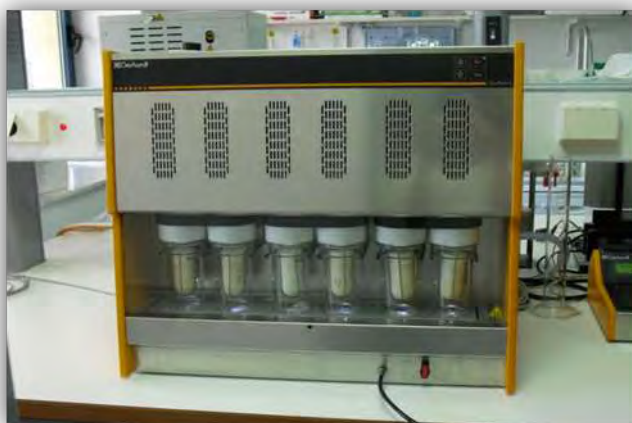
Εικόνα 17: Συσκευή εκχύλισης (Soxtherm της Gerhardt, φωτογραφία συγγραφέα).
