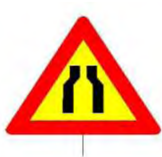
Σχήμα 2.11 : K-5 Επικίνδυνη στένωση οδοστρώματος και στις δύο πλευρές
