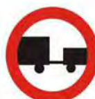
P-14 Απαγορεύεται η είσοδος σε μηχανοκίνητο όχημα το οποίο σέρει ρυμολκούμενο, πλην ημρυμολκούμενου ή ρυμολκούμενου ενός άξονα.
