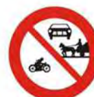
P-20 Απαγορεύεται η είσοδος σε οχήματα ορισμένων κατηγοριών (π.χ. σε μηχανοκίνητα και ζώηλα οχήματα).
