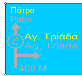
Σχήμα.2.2 : Πινακίδα Π-2 Προειδοποιητική κατευθύνσεων η οποία τοποθετείται στις οδούς ταχείας κυκλοφορίας προ διακλαδώσεων με αναγραφές κατευθύνσεων και χιλιομετρικών αποστάσεων
