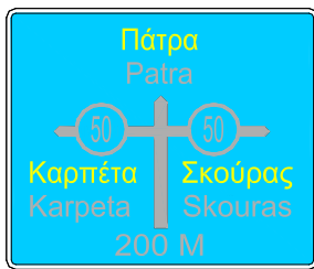
Σχήμα.2.1: Πινακίδα Π-1 Προειδοποιητική κατευθύνσεων η οποία τοποθετείται στις οδούς ταχείας κυκλοφορίας προ διασταυρώσεων με αναγραφές κατευθύνσεων και χιλιομετρικών αποστάσεων
