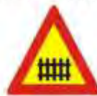
K-31 Κίνδυνος λόγω ισόπεδης σιδηροδρομικής διάβασης ή διάβασης τροχιοδρόμου με κινητά φράγματα.
