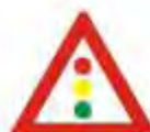
Κ-21 Προσοχή, κόμβος ή θέση όπου η κυκλοφορία ρυθμίζεται με τριχρωμή φωτεινή σηματοδότηση.
