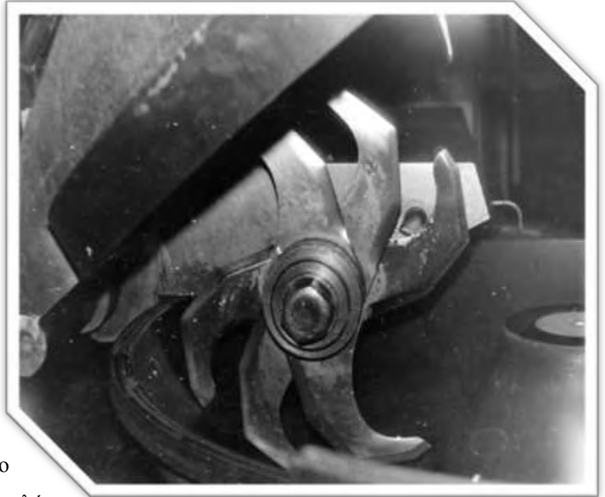
Εικόνα 4 το κούτερ με τα μαχαίρια του.
