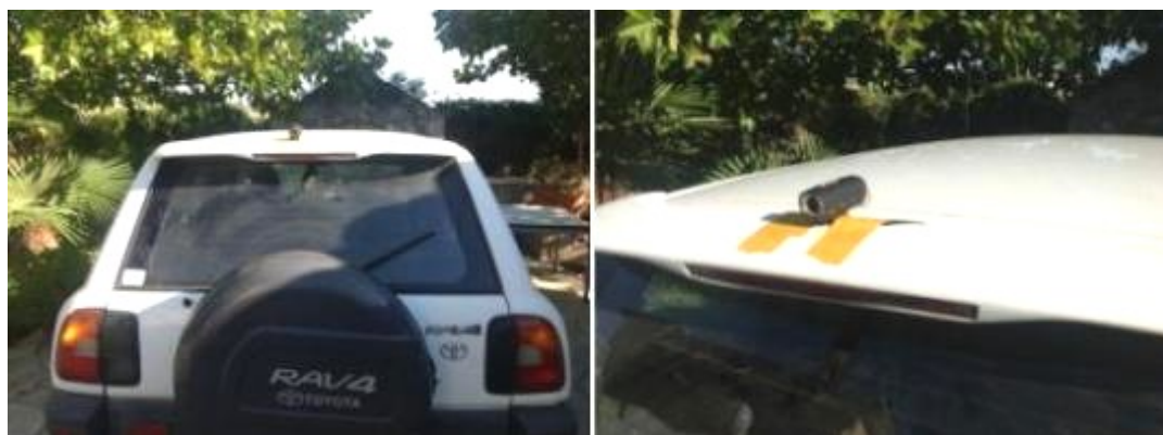
Εικόνα 26 Το αυτοκίνητο καταγραφής οδών που χρησιμοποιήθηκε με τοποθετημένη ψηφιακή κάμερα στο πίσω μέρος του
