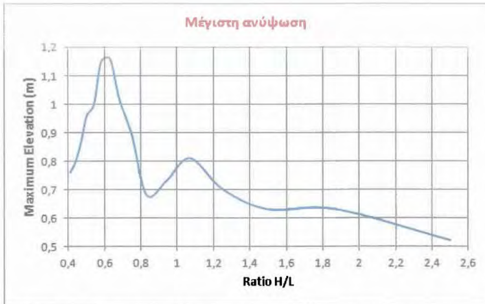
Εικόνα 7.2.2.6. Διάγραμμα μέγιστης ανύψωσης \eta_{(1)\max} της ελεύθερης επιφάνειας συναρτήσει του λόγου H/L ορθογωνικής δεξαμενής με H=15m, σεισμός Duzce (1999)
