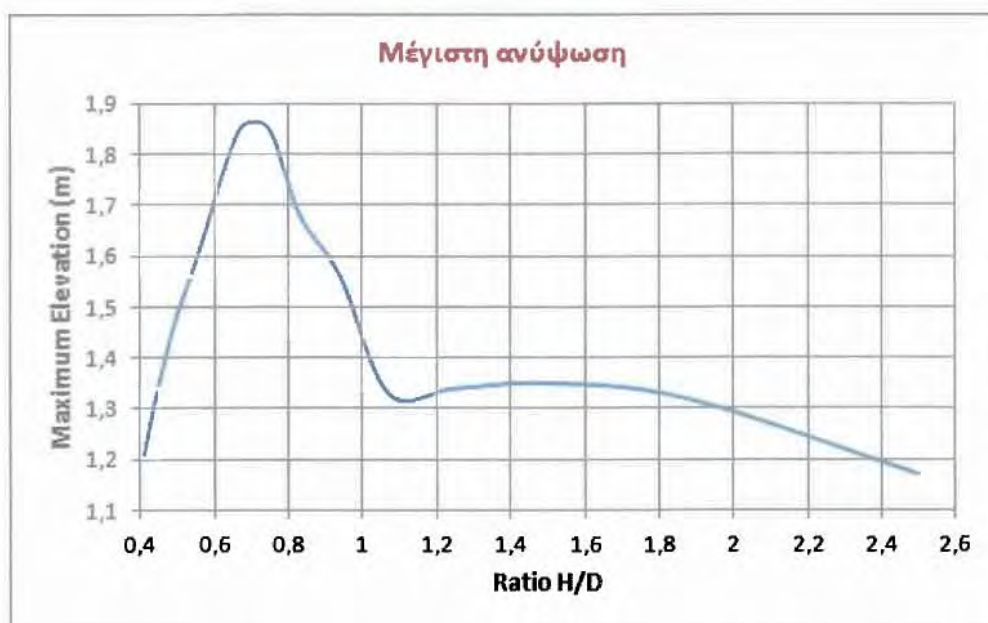
Εικόνα 7.2.1.10. Διάγραμμα μέγιστης ανύψωσης \eta_{(1)\max} της ελεύθερης επιφάνειας συναρτήσει του λόγου H/D κυλινδρικής δεξαμενής με H=15m, σεισμός Kocaeli (1999)
