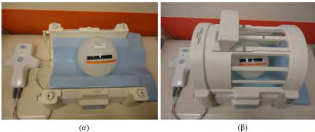
Εικόνα 4.1.1: Σφαιρικό ομοίωμα φασματοσκοπίας (α) τοποθετημένο σε πηνίο εγκεφάλου τύπο birdcage (β).
