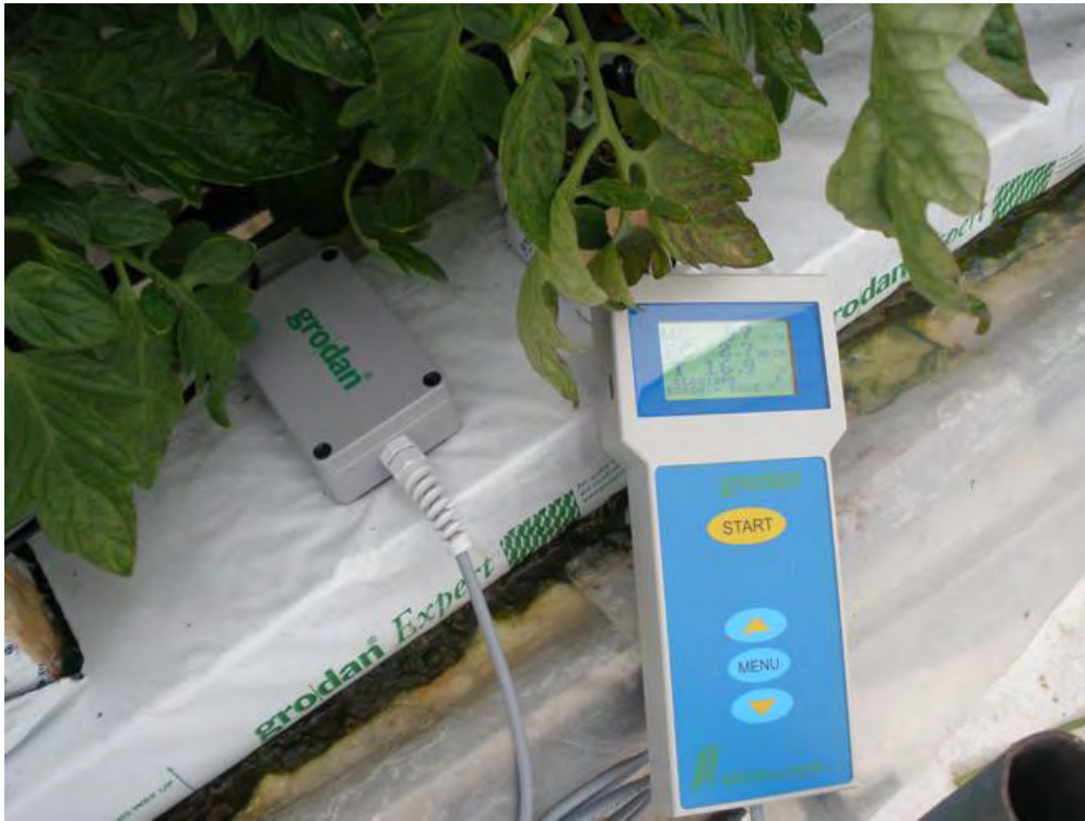
Εικόνα 3 Το Water Content Meter (WCM-Control) της Grodan
