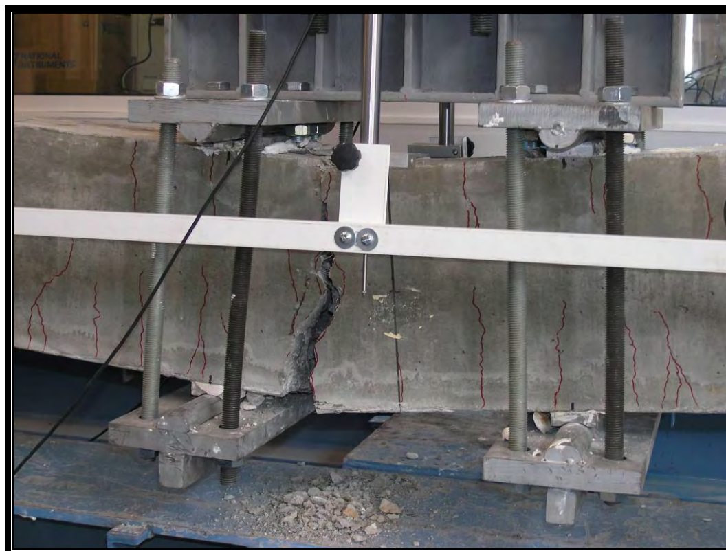
Σχ. 3 - Λεπτομέρεια της περιοχής αστοχίας.
