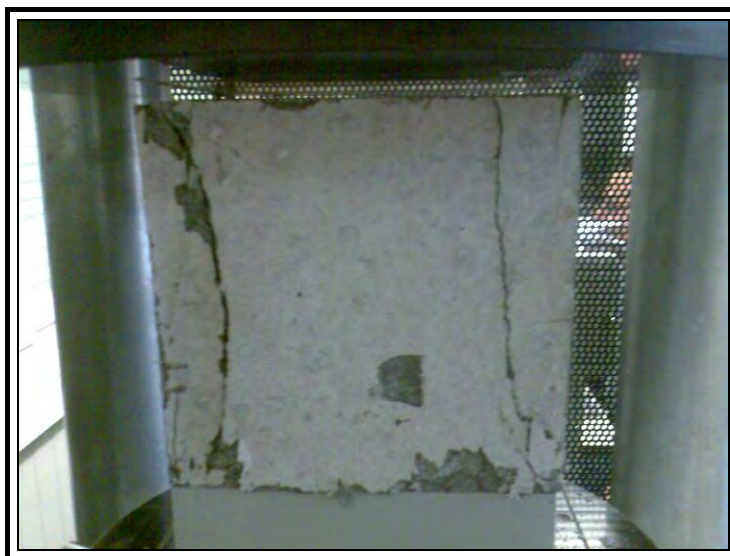
Σχήμα 2.24 - Κυβικό δοκίμιο ινοπλισμένου τσιμεντοκονιάματος μετά την αστοχία σε δοκιμή μονοαξονικής θλίψης.
