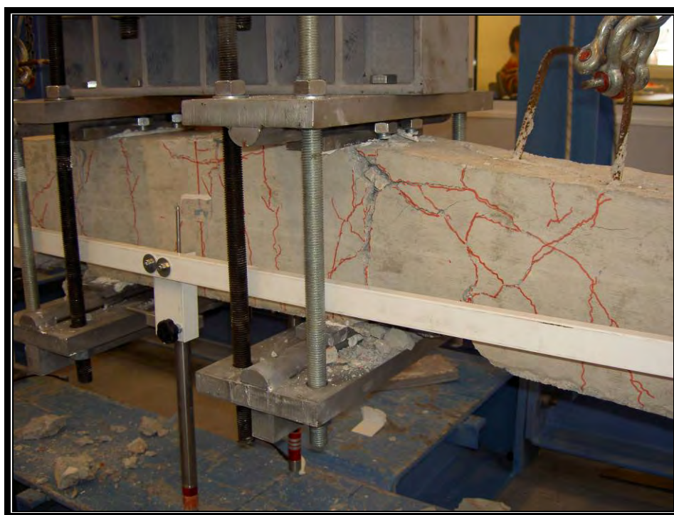
Σχήμα 3 - Λεπτομέρεια της περιοχής αστοχίας σε αρνητική ροπή.
