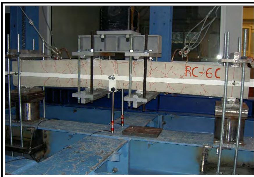
Σχήμα 7.29 - Ρηγμάτωση συμβατικά οπλισμένης δοκού σε ανακυκλιζόμενη φόρτιση κάμψης 4-σημείων.
