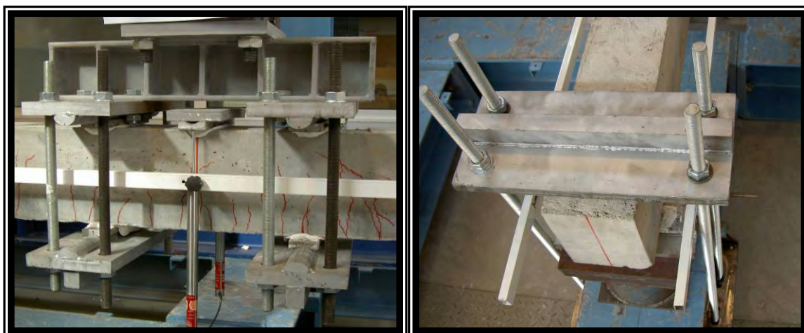
Σχήμα 3.9 - Λεπτομέρεια της πειραματικής διάταξης σε ανακυκλιζόμενη φόρτιση στη θέση της επιβολής του φορτίου (άνοιγμα δοκών) και στις στηρίξεις.
