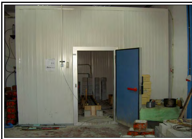
Σχήμα 2.8 - Ο θάλαμος συντήρησης των δοκών και δοκιμών σκυροδέματος και ινοπλισμένου τσιμεντοκονιάματος.
