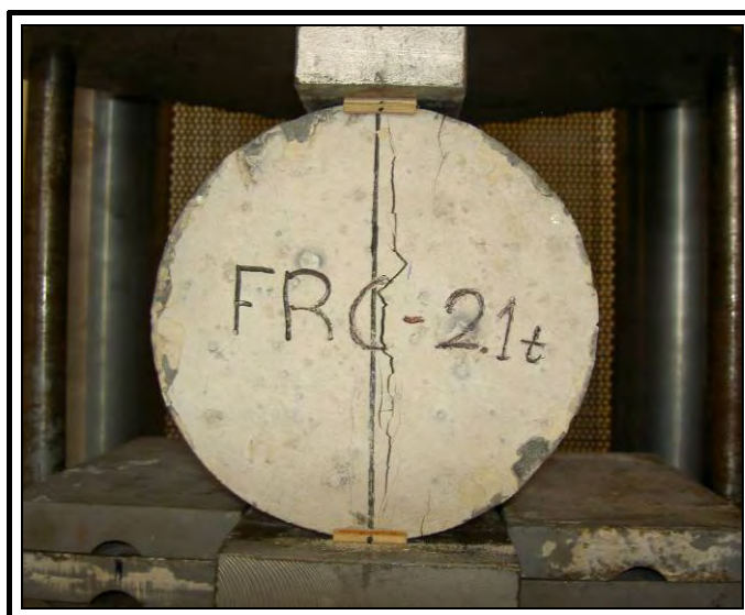
Σχήμα 2.29 - Κυλινδρικό δοκίμιο ινοπλισμένου τσιμεντοκονιάματος στο μέγιστο φορτίο στη δοκιμή έμμεσου εφελκυσμού.
