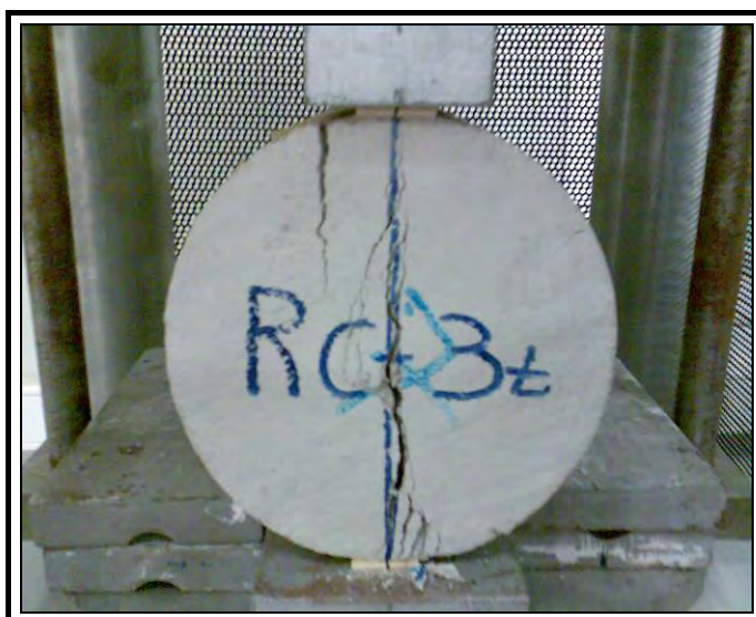
Σχήμα 2.27 - Κυλινδρικό δοκίμιο συμβατικού σκυροδέματος αμέσως μετά την αστοχία του σε δοκιμή έμμεσου εφελκυσμού.
