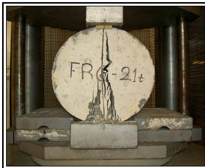
Σχήμα 2.30 - Το κυλινδρικό δοκίμιο ινοπλισμένου τσιμεντοκονιάματος μετά την αστοχία στη δοκιμή έμμεσου εφελκυσμού.
