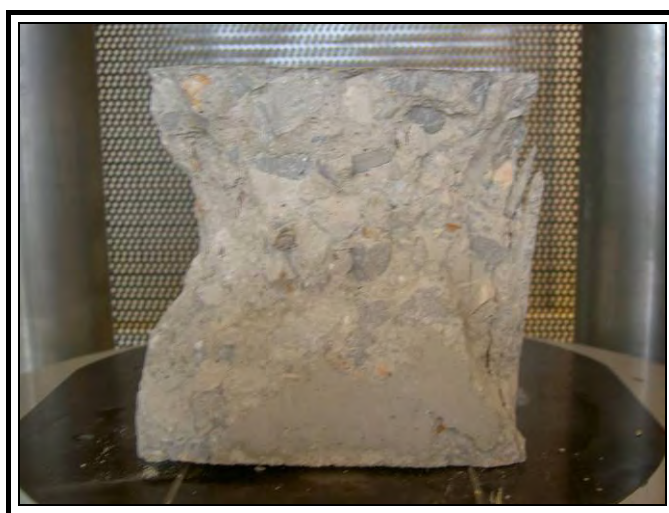
Σχήμα 2.21 - Κυβικό δοκίμιο συμβατικού σκυροδέματος μετά την αστοχία σε δοκιμή μονοαξονικής θλίψης.
