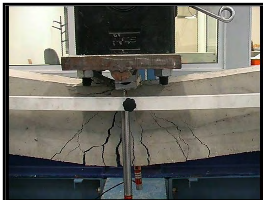
Σχήμα 3 - Λεπτομέρεια της περιοχής αστοχίας.
