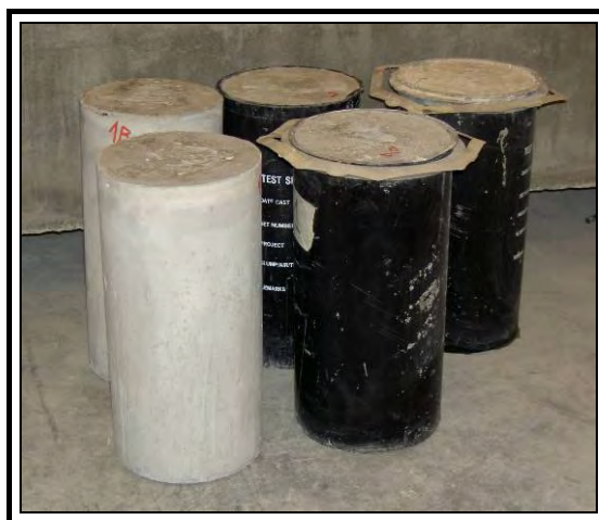
Σχήμα 2.10 - Κυλινδρικά δοκίμια σκυροδέματος.
