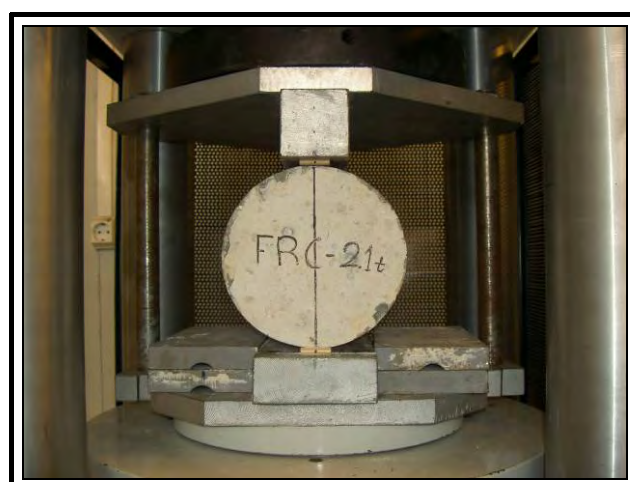
Σχήμα 2.19 - Κυλινδρικό δοκίμιο για τη δοκιμή έμμεσου εφελκυσμού.
