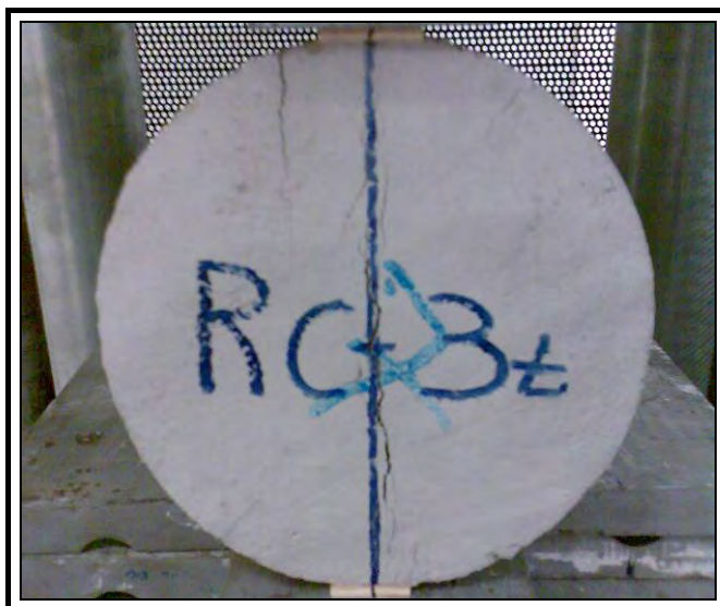
Σχήμα 2.26 - Κυλινδρικό δοκίμιο συμβατικού σκυροδέματος κατά την αστοχία σε δοκιμή έμμεσου εφελκυσμού.
