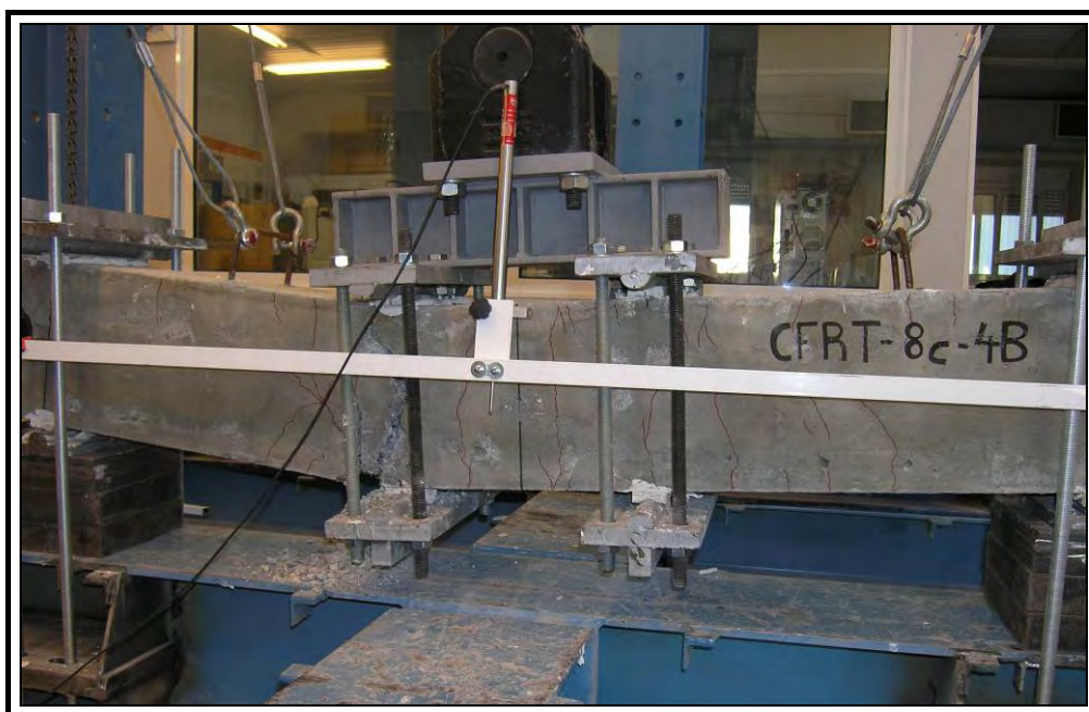
Σχήμα 7.28 - Ρηγμάτωση ενισχυμένης δοκού με ινοπλισμένο μανδύα σε ανακυκλιζόμενη φόρτιση κάμψης 4-σημείων.
