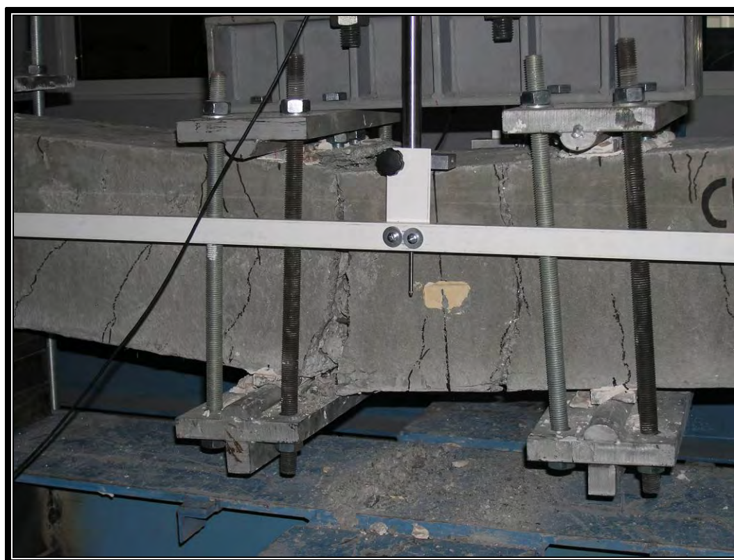
Σχ. 3 - Λεπτομέρεια της περιοχής αστοχίας.
