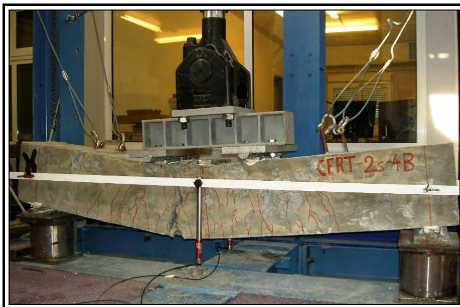
Σχήμα 6.12 – Αστοχία ενισχυμένης δοκού με ινοπλισμένο μανδύα σε στατική μονοτονική φόρτιση κάμψης 4-σημείων.
