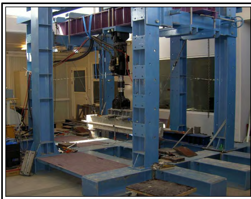
Σχήμα 3.12 - Το σερβοϋδραυλικό σύστημα επιβολής φορτίου MTS.
