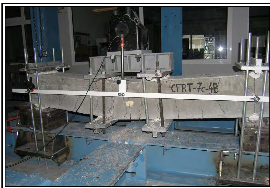
Σχήμα 7.30 - Αστοχία ενισχυμένης δοκού με ινοπλισμένο μανδύα σε ανακυκλιζόμενη φόρτιση κάμψης 4-σημείων.
