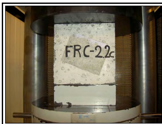
Σχήμα 2.18 - Κυβικό δοκίμιο για τη δοκιμή μονοαξονικής θλίψης.
