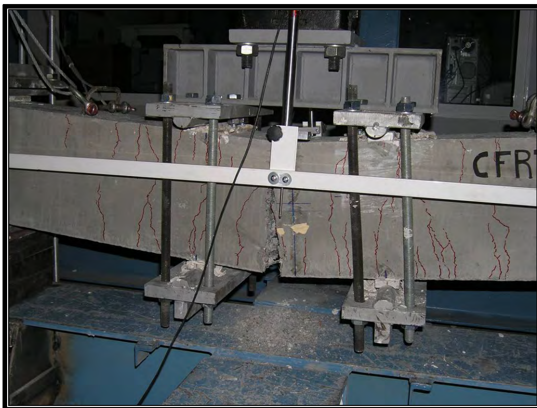
Σχ. 3 - Λεπτομέρεια της περιοχής αστοχίας.
