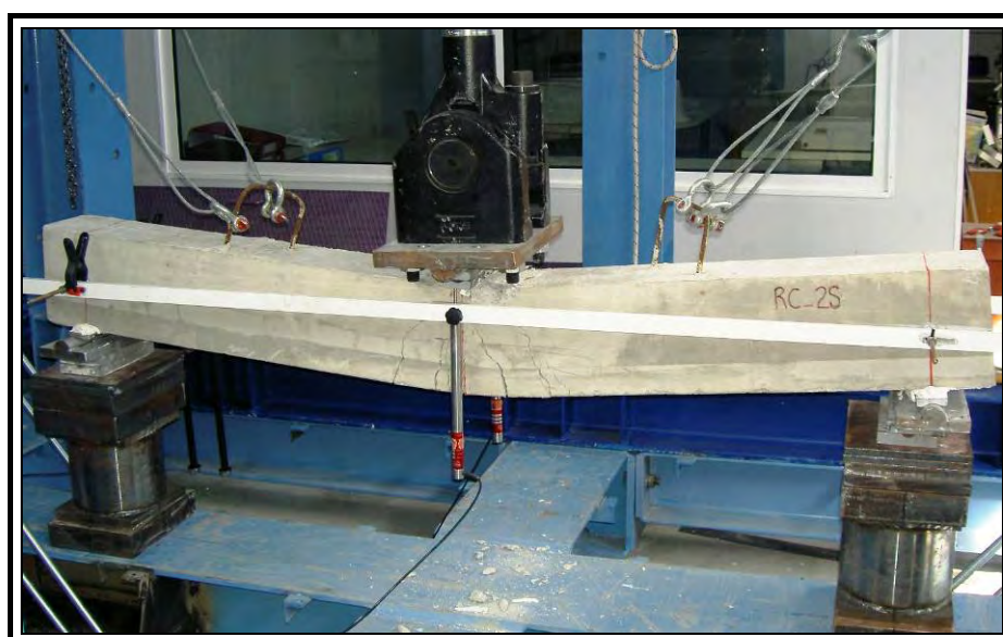
Σχήμα 6.11 – Ρηγμάτωση συμβατικά οπλισμένης δοκού σε στατική μονοτονική φόρτιση κάμψης 3-σημείων.
