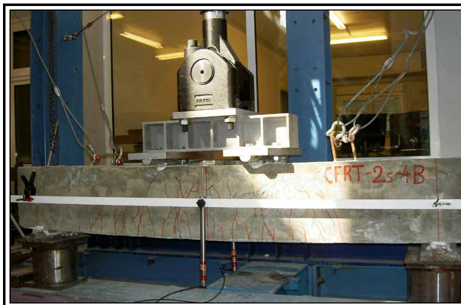
Σχήμα 6.10 – Ρηγμάτωση ενισχυμένης δοκού με ινοπλισμένο μανδύα σε στατική μονοτονική φόρτιση κάμψης 4-σημείων.
