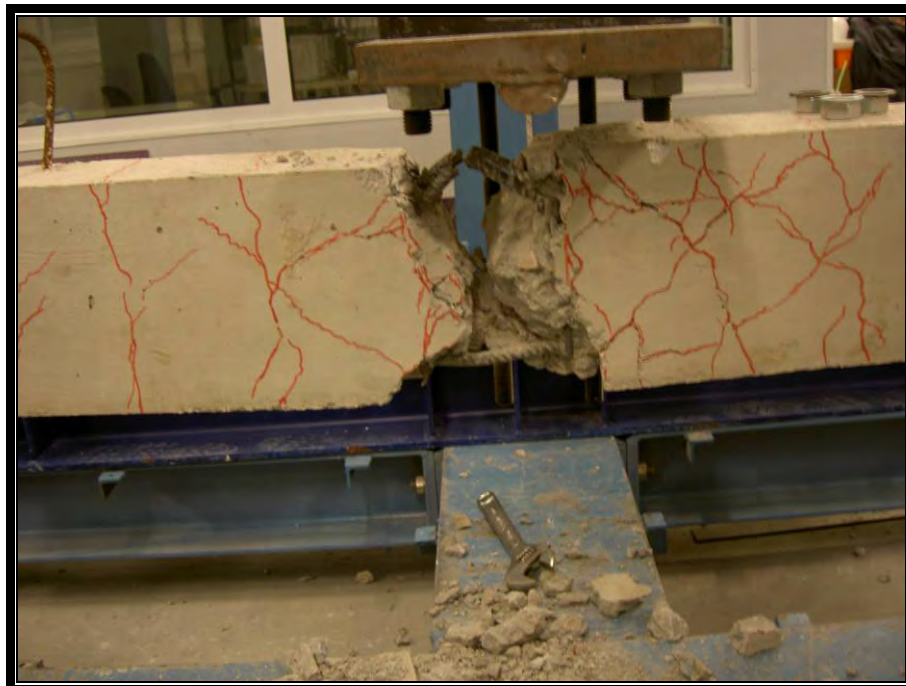
Σχήμα 3 - Λεπτομέρεια της περιοχής αστοχίας.
