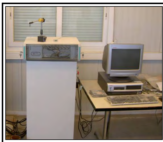
Σχήμα 3.15 - Αυτόματο σύστημα καταγραφής της πρέσας DMG.
