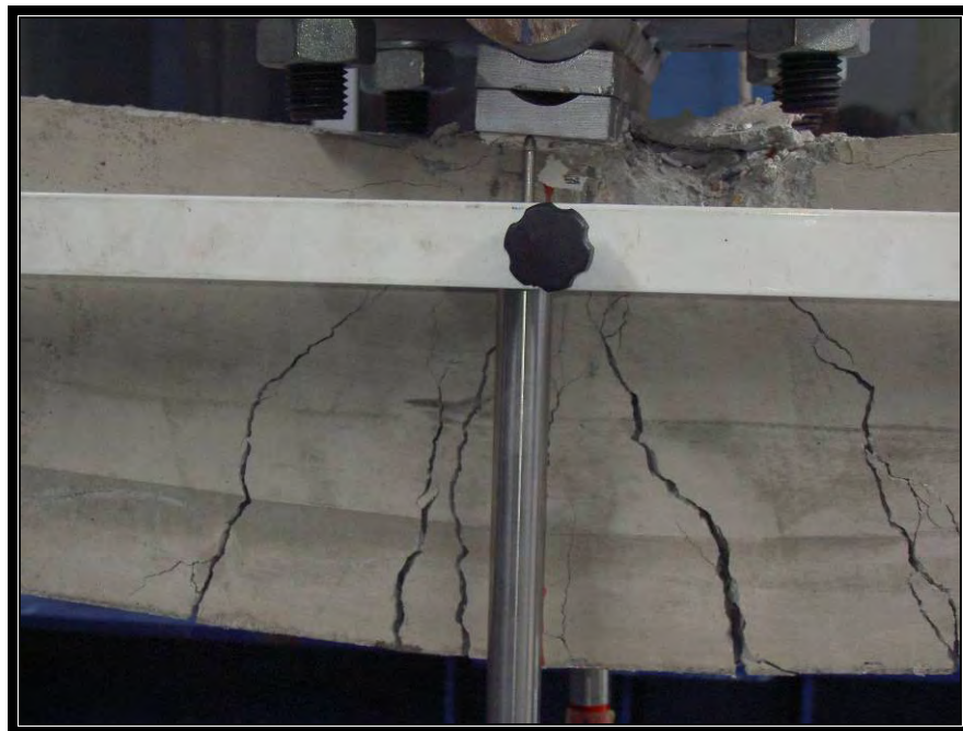
Σχήμα 3 - Λεπτομέρεια της περιοχής αστοχίας.
