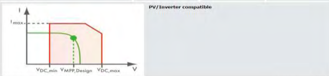
Εικόνα 5-1: Εκτύπωση από το λογισμικό Sunny Design για την συνδεσμολογία των 3393 panel τα 7254 συνολικά που έχουν ονομαστική ισχύ 270Wp και συνδέονται στους 87 από τους 186 συνολικά Inverters [25].
