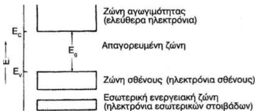
Εικόνα 2-5: Ενεργειακό διάκενο ημιαγωγών[1]
