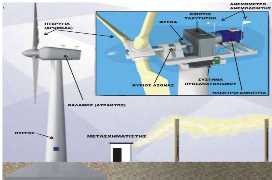
Εικόνα 5 : Κύρια μέρη μιας ανεμογεννήτριας.
