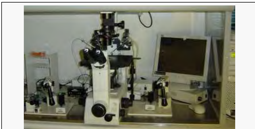
Εικόνα 30: Ανάστροφο μικροσκόπιο (Nikon), με μικροχειριστήρια για την εφαρμογή της μεθόδου γονιμοποίησης ICSI (Γένεσις Αθηνών).
