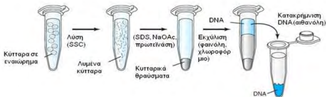
Εικόνα 14: Απομόνωση DNA από δείγμα περιφερικού αίματος (L. Buckingham et al, 2007).
