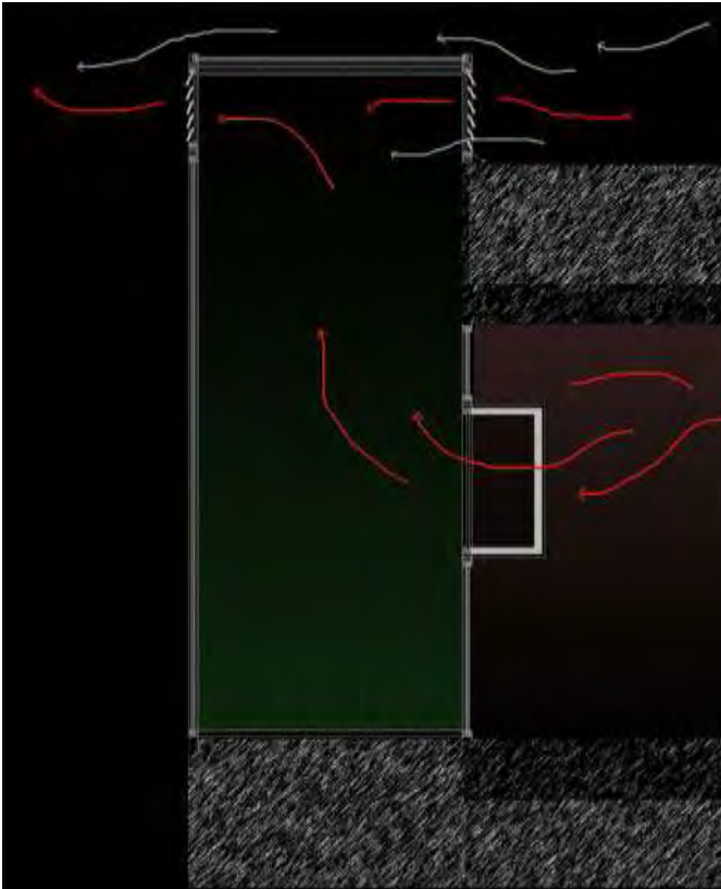
σκίτσο κίνησης αέρα μέσω των γυάλινων αεραγωγών
