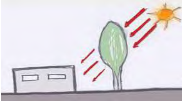
σκίαση το καλοκαίρι μέσω δενδροφύτευσης φυλλοβόλων δέντρων
