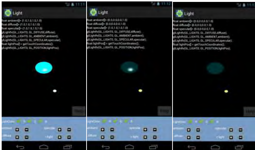
Εικόνα 40. Το διάνυσμα ambient με μέγιστες τιμές (αριστερά). Ενεργοποιημένο μόνο το διάνυσμα specular (μέση). Όλα τα διανύσματα με μηδενικές τιμές (δεξιά).
