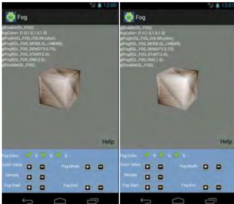
Εικόνα 44. Η γραμμική συνάρτηση GL_LINEAR. Η συνάρτηση με αλλαγμένο τον παράγοντα end (δεξιά).
