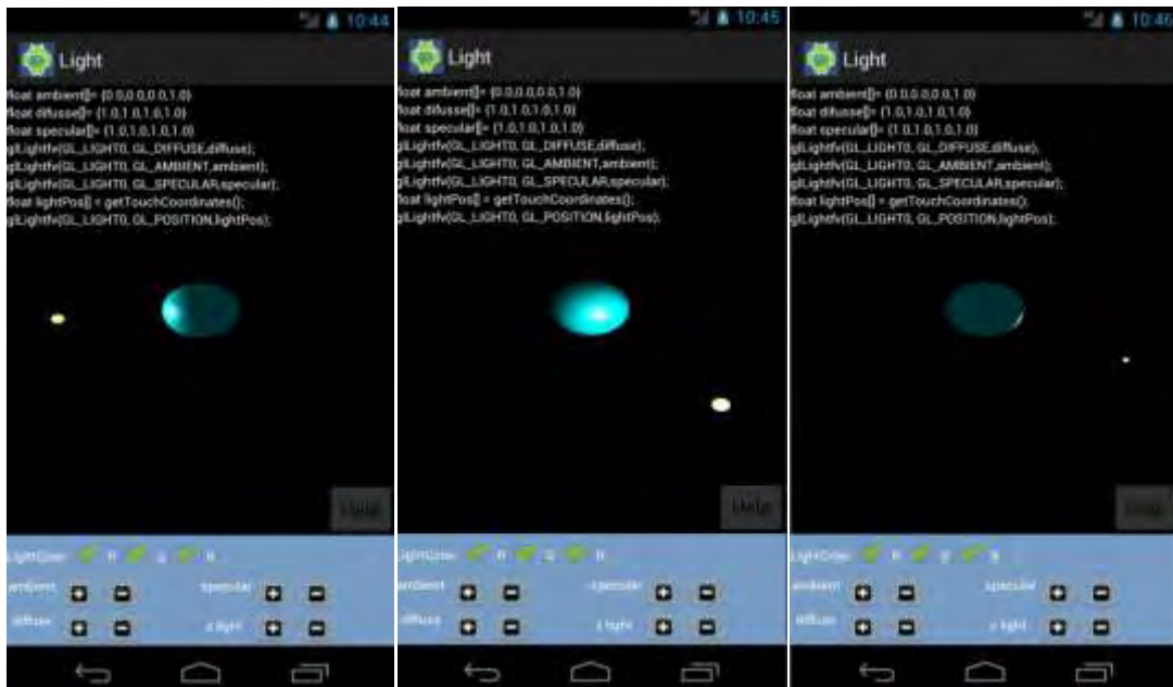
Εικόνα 38. Ο χρήστης μπορεί ακουμπώντας την θόνη να δώσει τις συντεταγμένες της πηγής φωτός και παράλληλα να μετακινήσει την κίτρινη σφαίρα. Η σφαίρα και η πηγή φωτός μπορούν να κινηθούν και κατά μήκος του άξονα z με τη χρήση του κουμπιού z light.
