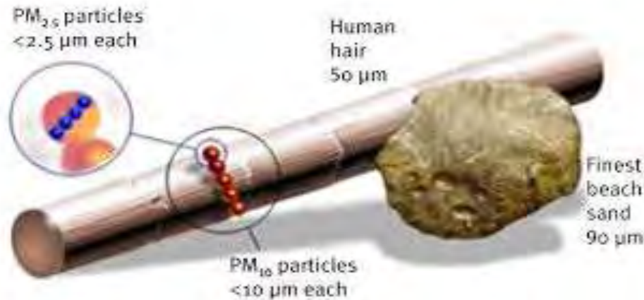
Εικόνα 2.2: Το μέγεθος των αιωρούμενων σωματιδίων PM 10 και PM 2,5 σε σχέση με την ανθρώπινη τρίχα.
