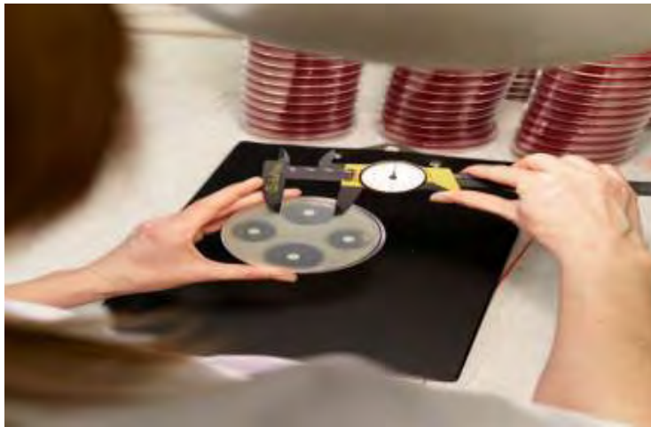
Εικόνα 14 : Μέτρηση διαμέτρου κύκλου αναστολής (παχύμετρο)
