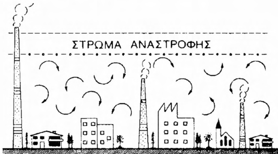
Σχήμα 2.3 : Σκιαγράφιση της θερμοκρασιακής αναστροφής σε μεγαλούπολη [35].
