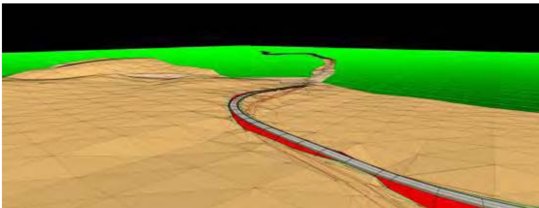
Θέση 2: Φωτογραφία τραβηγμένη από 3D. Ο μερισμός ξεκινάει από το σημείο συμβολής του νέου οδικού τμήματος με το παλιό, το οποίο διακρίνεται από τις κόκκινες οριογραμμές.
