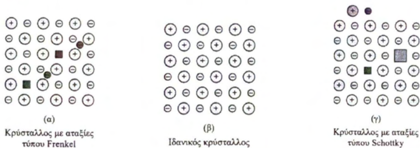
Σχήμα 14 Σημειακές ατέλειες σε κρυσταλλικά στερεά (point defects).
