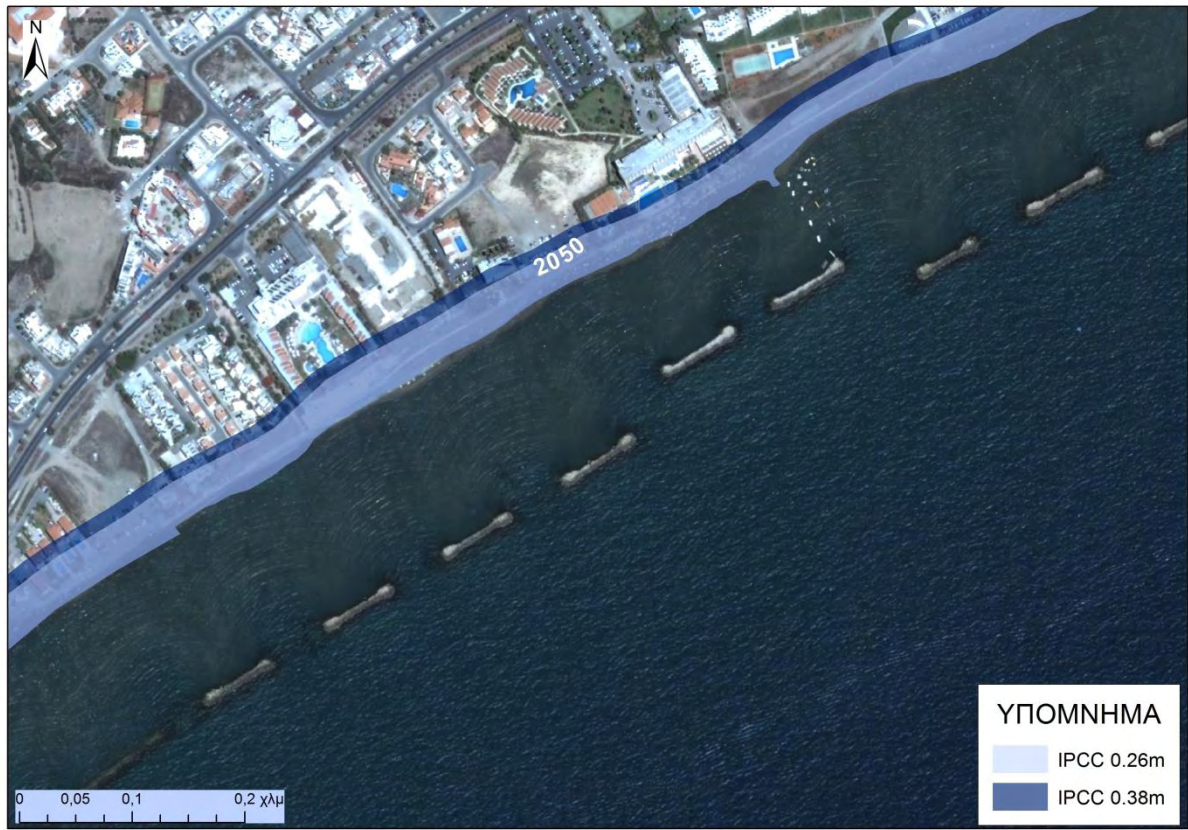
Εικόνα 32: Σενάρια 1 και 2 για ΑΣΘ 0,26μ, 0.38μ αντίστοιχα το έτος 2050 στην υπόπεριοχή Α
