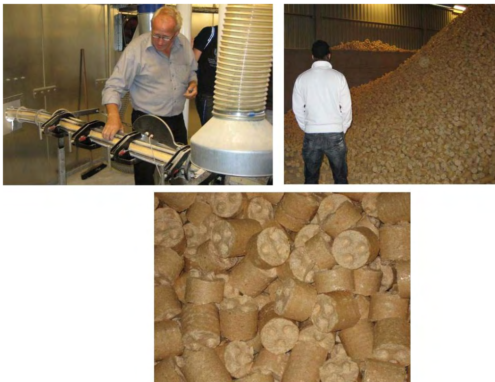
Εικόνα 17 Μπρικέτες που παράγονται από τρίμματα ξύλου: εργοστάσιο παραγωγής (πάνω αριστερά), αποθήκευση μπρικετών (πάνω δεξιά) κοντινή λήψη μπρικετών ξύλου (κάτω) ( http://bisyplan.bioenarea.eu/html-files-gr/01-01.pdf )
