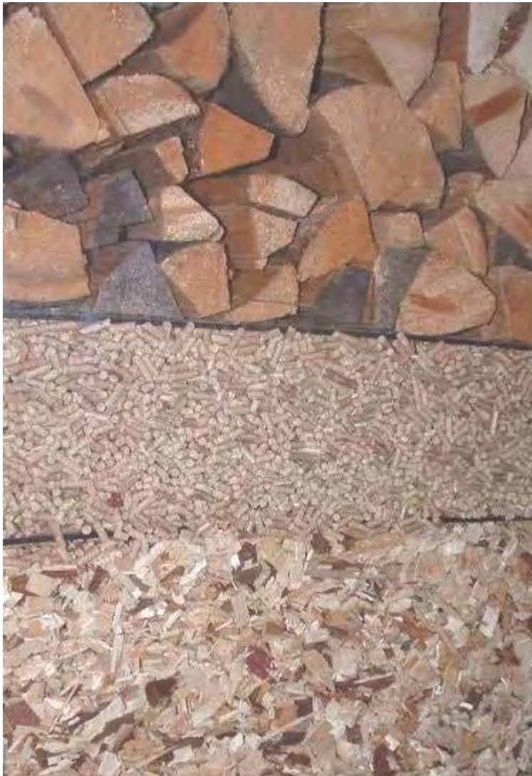
Εικόνα 19 Άμεση οπτική σύγκριση των τριών βασικών καυσίμων από ξυλώδη βιομάζα καυσόξυλο (επάνω), πελλέτες (κέντρο) και θρύμματα ξύλου (κάτω).
