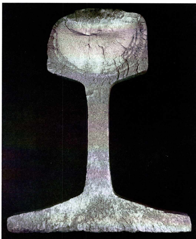
Σχήμα 2.5 Ρωγμή σχήματος «νεφρού» [4]
