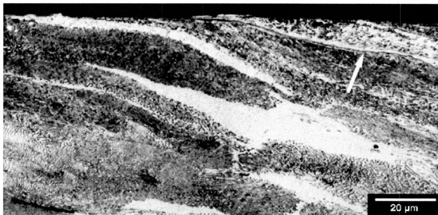
Σχήμα 2.7 Έναρξη ρωγμής κόπωσης σε περιοχή έντονης πλαστικής παραμόρφωσης [14]
