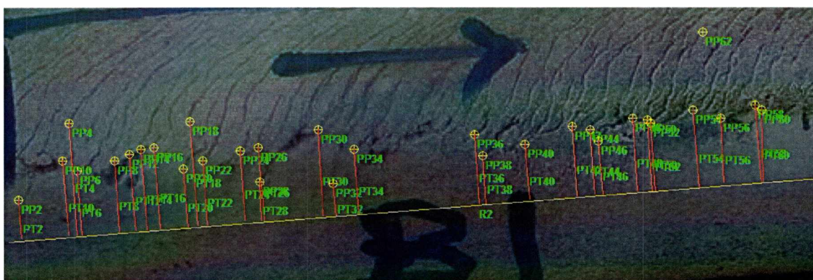
Σχήμα 4.7 Μέτρηση της απόστασης του άκρου της ρωγμής από το gauge corner (περιοχή B1)
