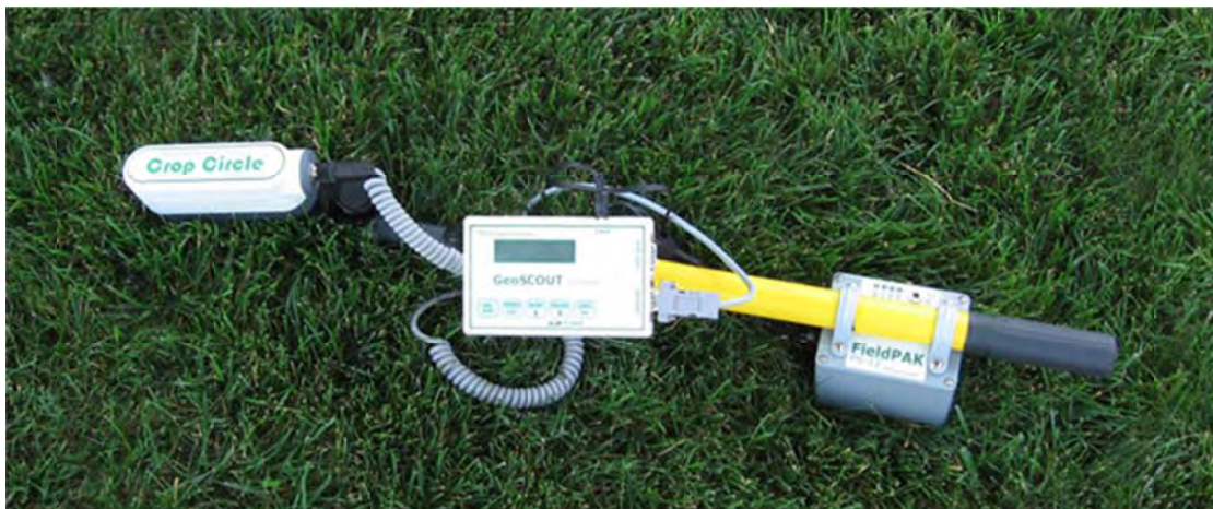
Εικόνα 5.1. Ο αισθητήρας Crop Circle ACS 210 και ο καταγραφέας δεδομένων Geoscout GLS-400 που χρησιμοποιήθηκαν στην μελέτη.
