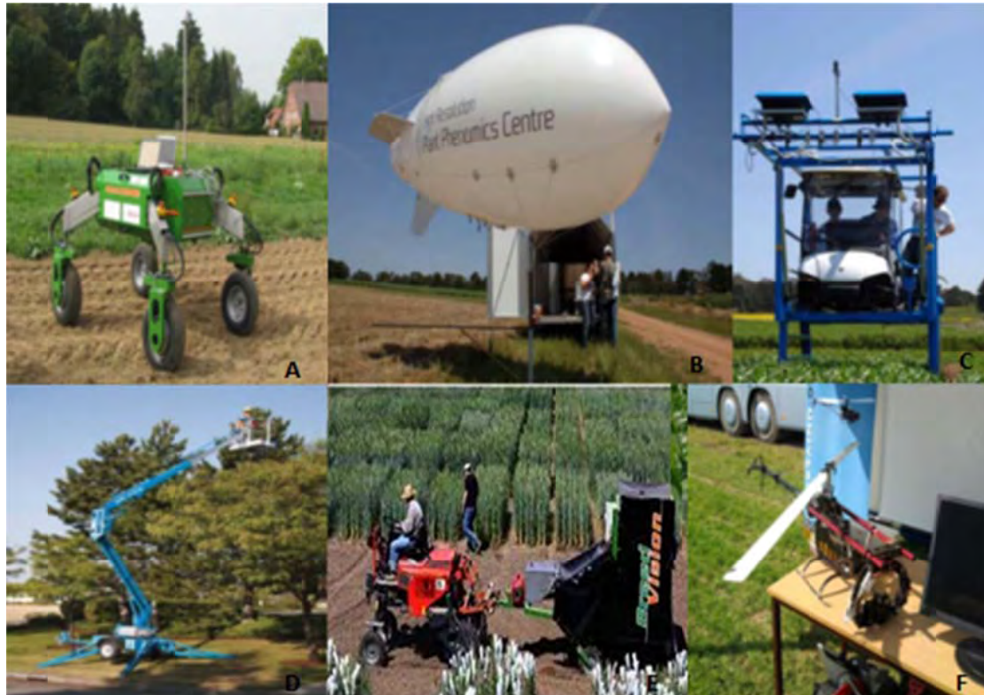
Εικόνα 1.1. Πλατφόρμες αισθητήρων για μελέτη φαινοτύπου (A) BoniRob, (B) Μη επανδρωμένο αερόπλοιο, (C) Phenomobile, (D) Ανυψωτική πλατφόρμα, (E) BreedVision, (F) Μη επανδρωμένο ελικόπτερο (Deery et al., 2014).
