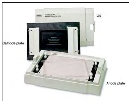
Εικόνα 3.7: Ηλεκτρομεταφορά πρωτεϊνών σε σχεδόν υγρό περιβάλλον (Semi-Dry Transfer), A) Απεικόνιση της συσκευής TRANS-BLOT και B) Σχηματική αναπαράσταση ηλεκτρομεταφοράς πρωτεϊνών σε μεμβράνη νιτροκυτταρίνης. Ανατύπωση από: www.bio-rad.com
