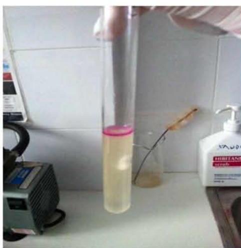
Εικόνα 23: Θετική αντίδραση ινδόλης σε διάλυμα βακτηριακής πεπτόνης για την επιβεβαιωτική δοκιμή παρουσίας E.coli
