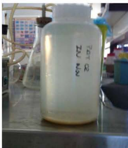
Εικόνα 26: Σχηματισμός σύννεφου μετά από την προσθήκη Al_2(SO_4)_3 & NaOH
