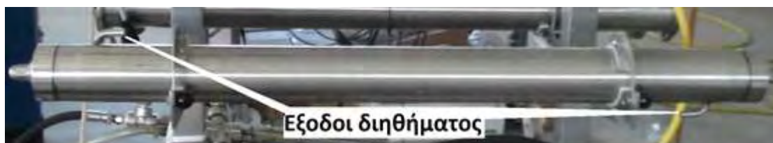
Εικόνα 22: Στήλη αποχρωματισμού. Χρησιμοποιήθηκαν οι μεμβράνες υπερδιήθησης: CA 202, ESP 04, EM 006, PU 608)
