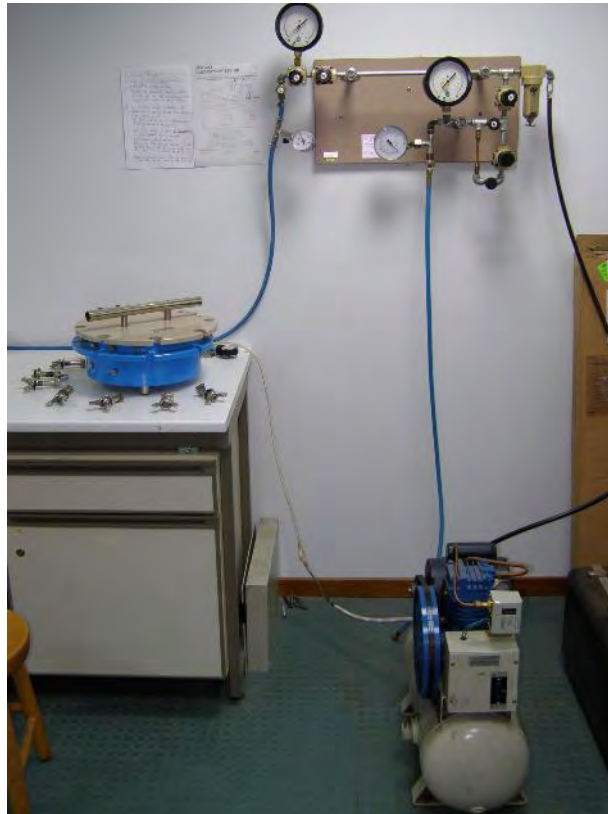
Εικόνα 2.3: Το σύστημα προσδιορισμού της χαρακτηριστικής καμπύλης του εδάφους.
