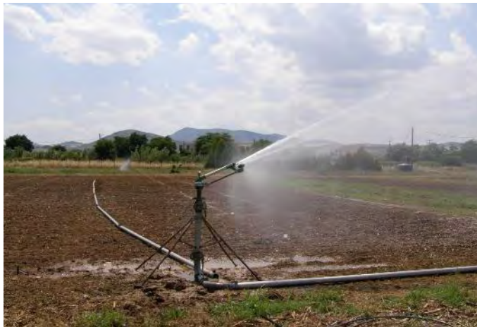
Εικόνα 2.17: Ο υψηλής πίεσης περιστρεφόμενος καταιονιστήρας.
