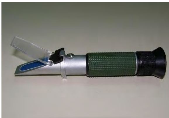
Εικόνα 2.22: Το φορητό διαθλασίμετρο 53000C, της εταιρείας Turoni.
