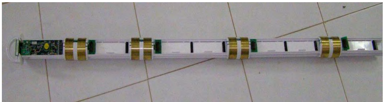
Εικόνα 2.26: Το σύστημα EnviroSCAN με τέσσερις αισθητήρες.
