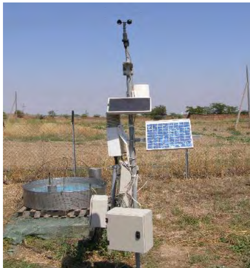
Εικόνα 2.28: Ο αυτόματος μετεωρολογικός σταθμός του Εργαστηρίου Γεωργικής Υδραυλικής.
