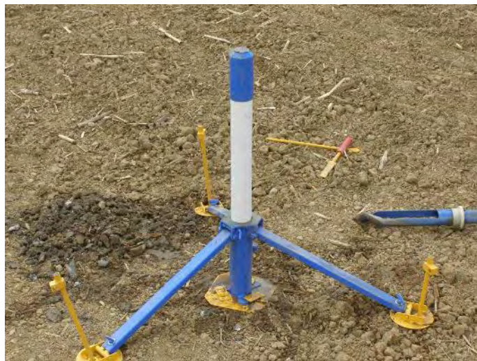
Εικόνα 2.23: Εισαγωγή ενός αγωγού πρόσβασης στο έδαφος με τη συλλογή εργαλείων της εταιρείας Sentek.
