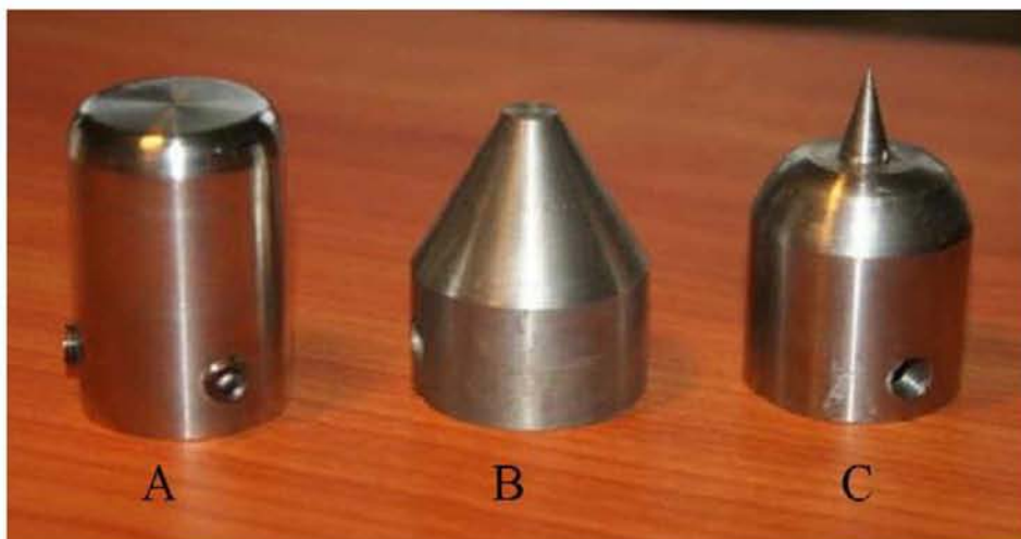
Εικόνα 1. Απεικόνιση ειδικών σφυριών (όπου Α. το επίπεδο, Β. το κωνικό και C. με ακίδα) τα οποία χρησιμοποιούνται σε ειδικά αυτοματοποιημένα μηχανήματα για την θανάτωση των ψαριών (Roth et al. 2007)
