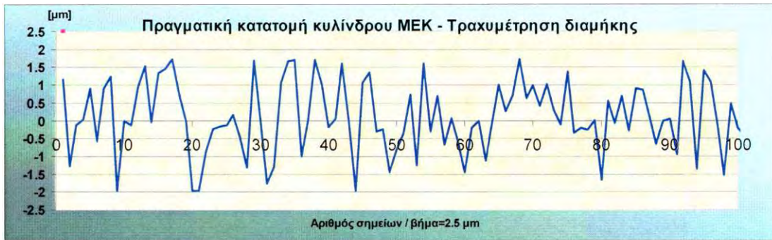
Σχήμα 3.1.3.13 Κατατομή κατά μήκος της γενέτειρας του κυλίνδρου, μήκος \mu 5000 \mu , \mu 100 \mu , \mu 2000.
