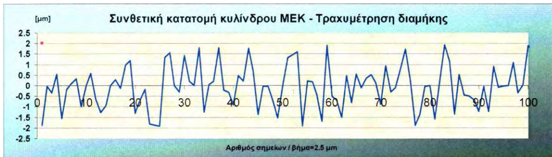
Σχήμα 3.3.1 Συνθετική κατατομή κατά μήκος της γενέτειρας του κυλίνδρου, μήκος \mu 5000 pm, \mu 100 \mu 2000, = 1.01 pm.
