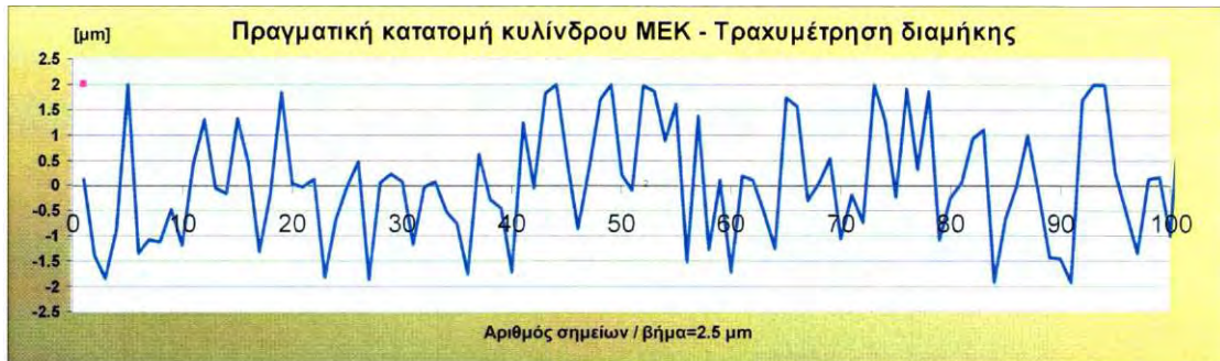
Σχήμα 2.3.14 Τραχυμέτρηση τυχαίου δείγματος σε αρχική κατάσταση, \sigma = 1.2 \mu\text{m}
