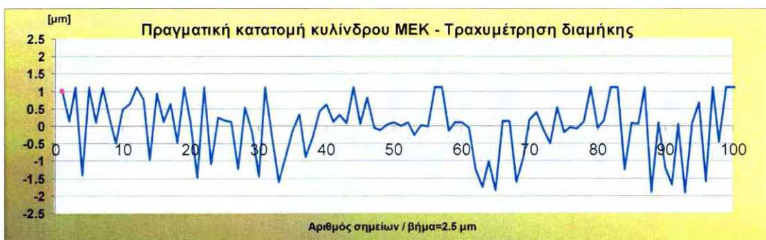
Σχήμα 2.3.16 Τραχυμέτρηση τυχαίου δείγματος στο πρώτο στάδιο φθοράς, \sigma = 0.95 \mu\text{m}
