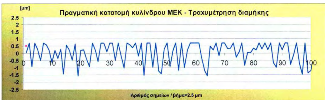
Σχήμα 2.3.17 Τραχυμέτρηση τυχαίου δείγματος μετά το στρώσιμο, \sigma = 0.8 \mu\text{m}
