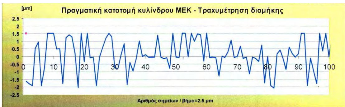
Σχήμα 2.3.15 Τραχυμέτρηση τυχαίου δείγματος στο πρώτο στάδιο φθοράς, \sigma = 1.1 \mu\text{m}
