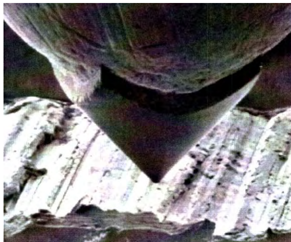
Εικόνα 1.6.1(α): Καμπυλότητα στυλίσκου – φθορά στυλίσκου.
