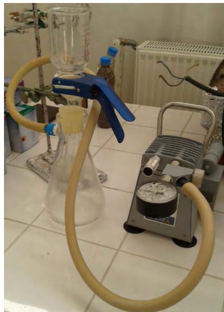
Εικόνα 4.5: Διάταξη διήθησης με την κωνική φιάλη συνδεδεμένη με αντλία πίεσης
