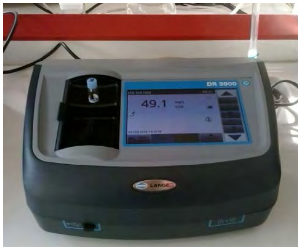
Εικόνα 4.6: Φωτόμετρο DR 3900 μέτρησης φυσικοχημικών χαρακτηριστικών σε νερά και υγρά απόβλητα
