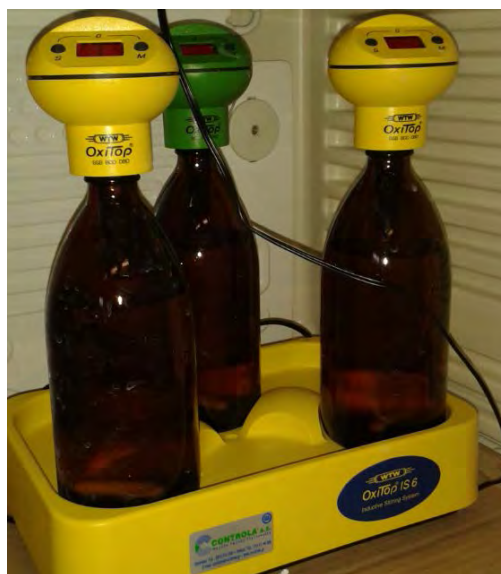
Εικόνα 4.7: Ειδικές φιάλες μέτρησης \text{BOD}_5 τοποθετημένες στη συσκευή ανάδευσης
