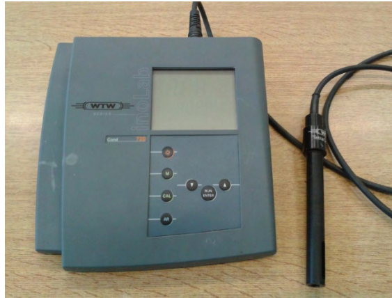
Εικόνα 4.2: Αγωγιόμετρο Inolab cond 720
