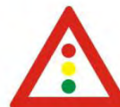
K-21 Προσοχή, κόμβος ή θέση όπου η κυκλοφορία ρυθμίζεται με τριχρώμη φωτεινή σηματοδότηση.
