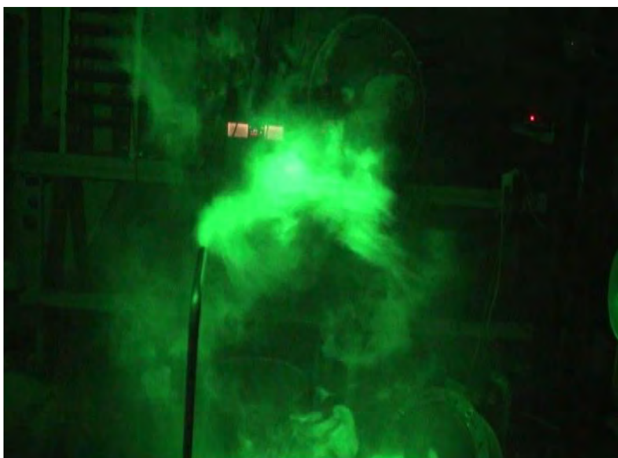
Εικόνα 3.2 Ροικό πεδίο με τη χρήση καπνογόνου υπό την επίδραση συνθετικής ομογενούς κι ισότροπης τύρβης με τη χρήση των μεγαφώνων
