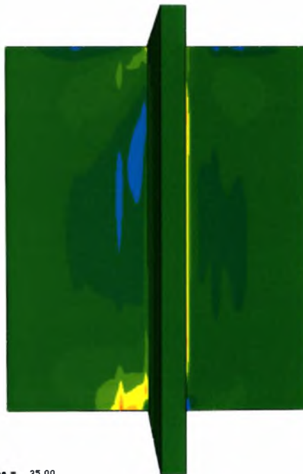
Σχήμα 5.16β 2 : Ισοϋψείς τάσεως \sigma_{11} για για t=25\text{sec} .
