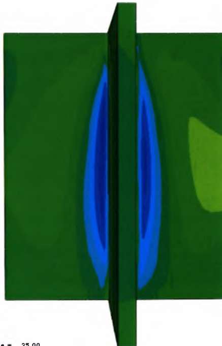
Σχήμα 5.22β 2 : Ισοϋψείς τάσεως \sigma_{33} για t=25\text{sec} .
