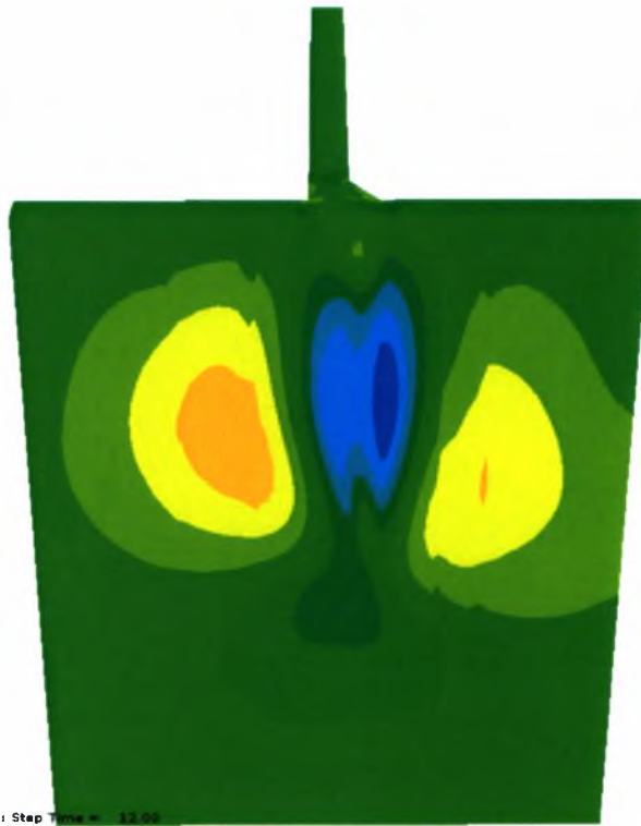
Σχήμα 5.21γ : Ισοΰψεις της τάσεως \sigma_{33} για t=12\text{sec} .
