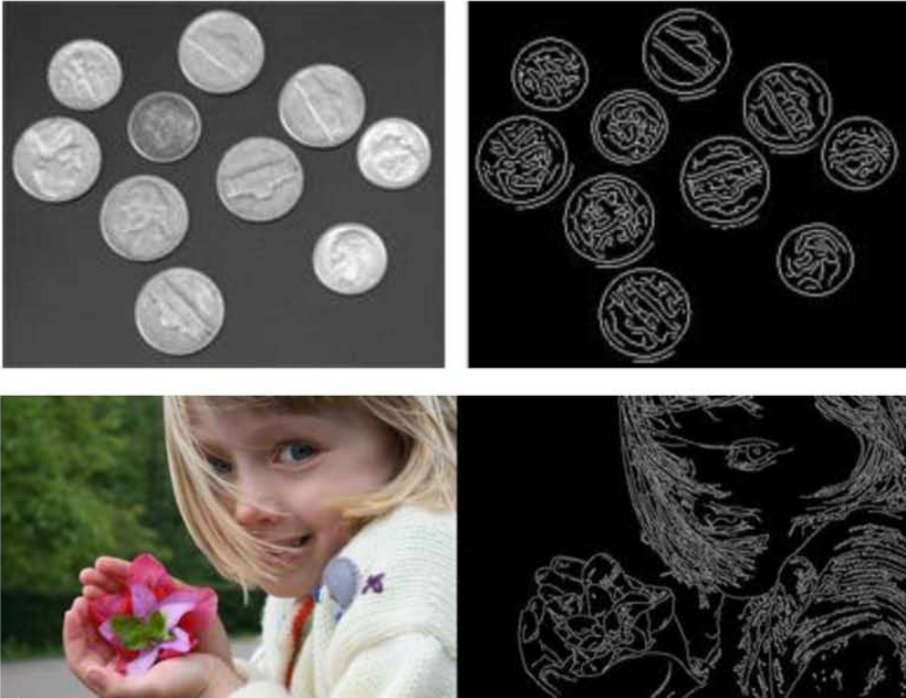
Εικόνα 5.1: Εικόνες πριν και μετά την εφαρμογή του αλγορίθμου Canny edge detector.
