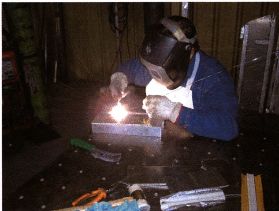
Σχήμα 2.6 Συγκόλληση TIG στο εργοστάσιο Κιολεϊδης Α.Ε.Β.Ε.
