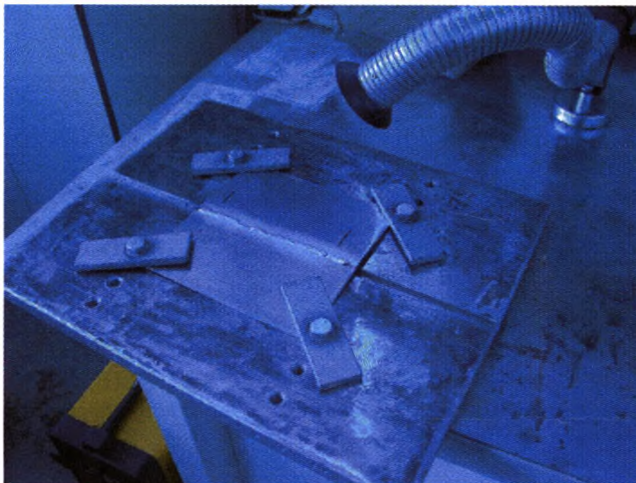
Σχήμα 3.3 Η βάση όπου συγκρατήθηκαν τα δοκίμια για να συγκολληθούν. Διακρίνεται η άκρη του απαγωγού των αερίων συγκόλλησης.
