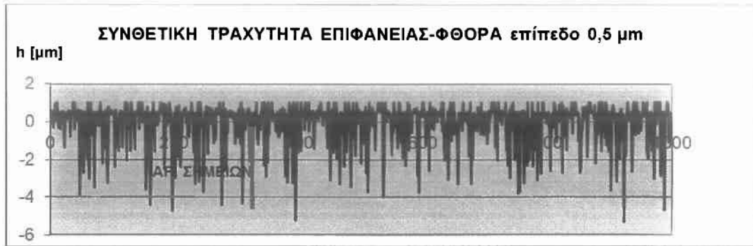
Σχήμα 1.2.3.: Ενδεικτική τραχυμέτρηση κατά μήκος του άξονα γ.
