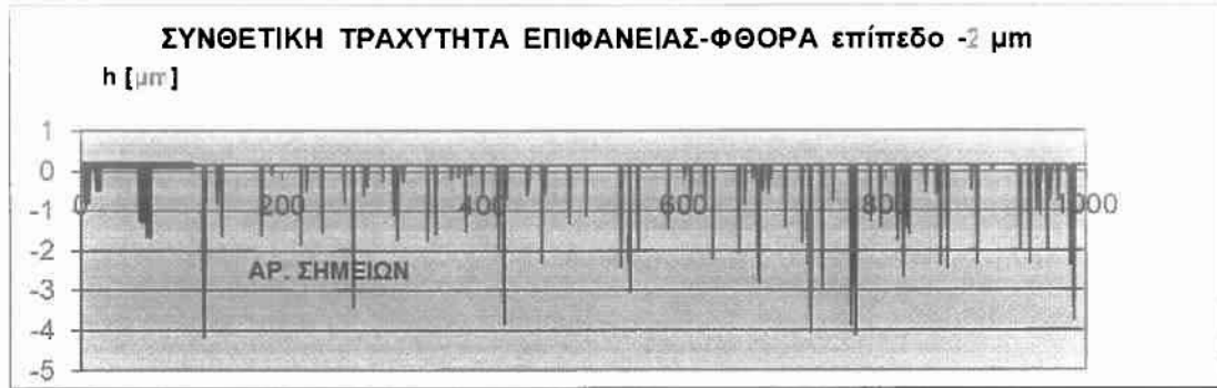
Σχήμα Π.2.5.17.: Κατατομή συνθετικής τραχύτητας (πρότυπο 5) για επίπεδο αποκοπής (φίλτρο φθοράς) w=2 \mu\text{m} .
