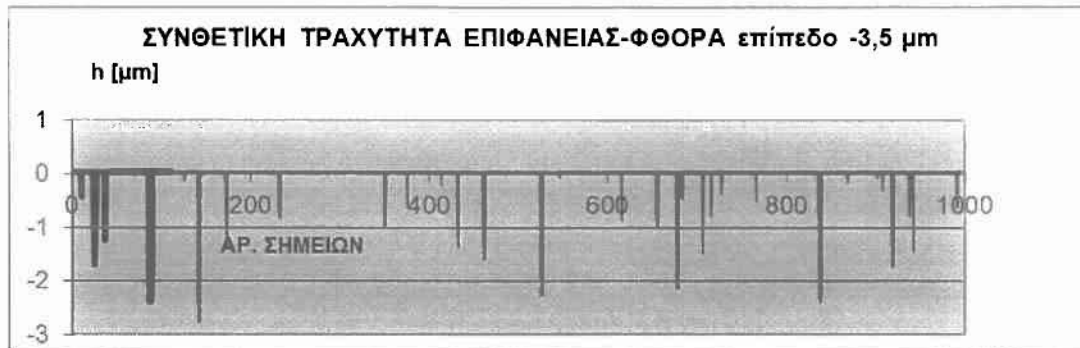
Σχήμα 2.5.5.3.: Κατατομή συνθετικής τραχύτητας (πρότυπο 5) για επίπεδο αποκοπής (φίλτρο φθοράς) w=-3.5 \mu\text{m} .
