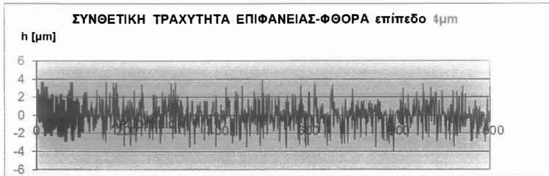
Σχήμα Π.2.1.3.: Κατατομή συνθετικής τραχύτητας (πρότυπο 1) για επίπεδο αποκοπής(φίλτρο φθοράς) w=4 \mu\text{m} .
