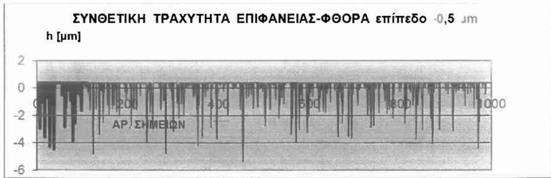
Σχήμα Π.2.5.11.: Κατατομή συνθετικής τραχύτητας (πρότυπο 5) για επίπεδο αποκοπής (φίλτρο φθοράς) w=-0.5 \mu\text{m} .
