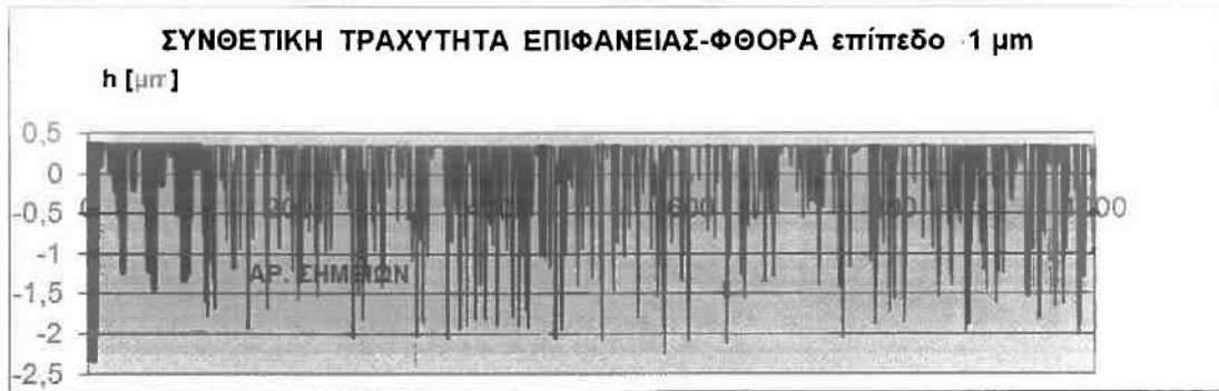
Σχήμα Π.2.4.17.: Κατατομή συνθετικής τραχύτητας (πρότυπο 4) για επίπεδο αποκοπής (φίλτρο φθοράς) w=1 \mu\text{m} .
