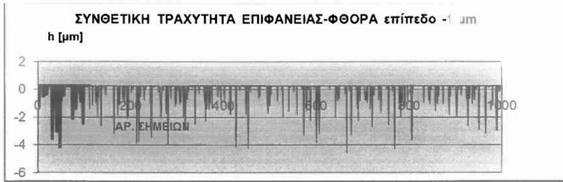
Σχήμα Π.2.5.13.: Κατατομή συνθετικής τραχύτητας (πρότυπο 5) για επίπεδο αποκοπής (φίλτρο φθοράς) w=-1 \mu\text{m} .
