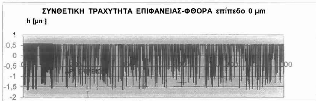
Σχήμα Π.2.2.13.: Κατατομή συνθετικής τραχύτητας (πρότυπο 2) για επίπεδο αποκοπής (φίλτρο φθοράς) w=0 \mu\text{m} .
