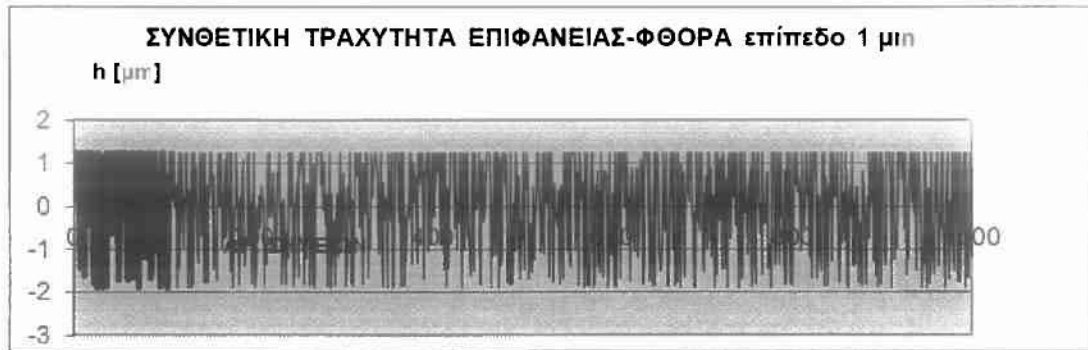
Σχήμα Π.2.3.7.: Κατατομή συνθετικής τραχύτητας (πρότυπο 3) για επίπεδο αποκοπής (φίλτρο φθοράς) w=1 \mu\text{m} .
