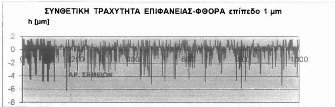
Σχήμα Π.2.5.5.: Κατατομή συνθετικής τραχύτητας (πρότυπο 5) για επίπεδο αποκοπής (φίλτρο φθοράς) w=1 \mu\text{m} .
