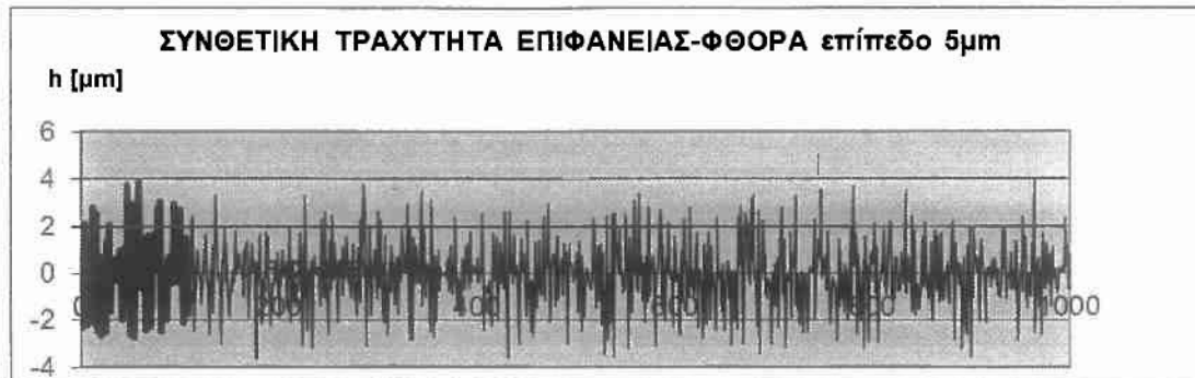
Σχήμα Π.2.1.1.: Κατατομή συνθετικής τραχύτητας (πρότυπο 1) για επίπεδο αποκοπής(φίλτρο φθοράς) w=5\mu\text{m} , στην συγκεκριμένη περίπτωση αρχική κατάσταση χωρίς φθορά.
