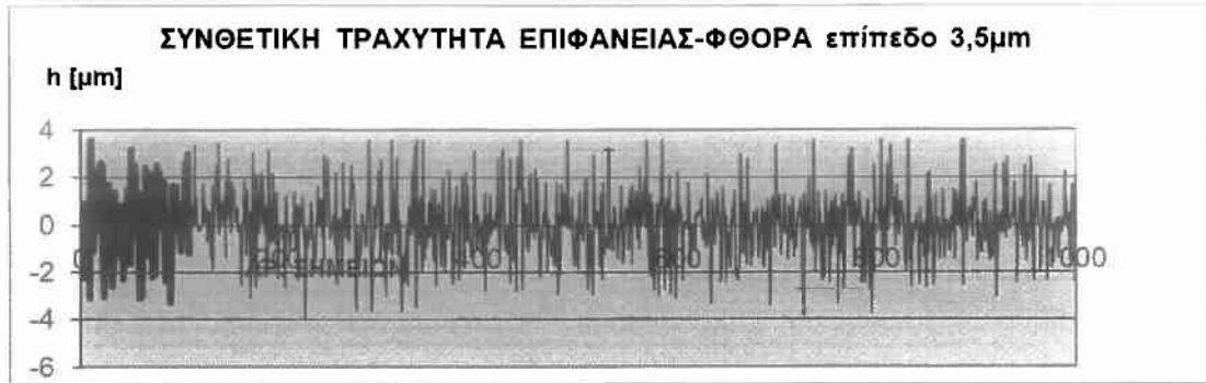
Σχήμα Π.2.1.5.: Κατατομή συνθετικής τραχύτητας (πρότυπο 1) για επίπεδο αποκοπής(φίλτρο φθοράς) w=3,5 \mu\text{m} .
