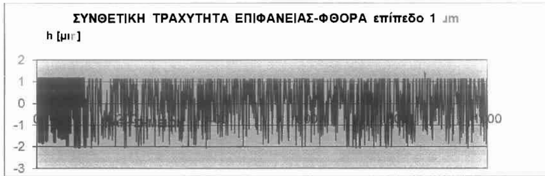
Σχήμα Π.2.2.9.: Κατατομή συνθετικής τραχύτητας (πρότυπο 2) για επίπεδο αποκοπής (φίλτρο φθοράς) w=1 \mu\text{m} .
