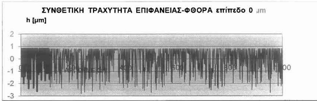
Σχήμα Π.2.4.13.: Κατατομή συνθετικής τραχύτητας (πρότυπο 4) για επίπεδο αποκοπής (φίλτρο φθοράς) w=0 \mu\text{m} .
