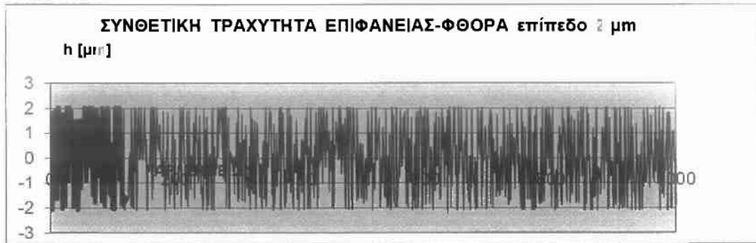
Σχήμα Π.2.3.3.: Κατατομή συνθετικής τραχύτητας (πρότυπο 3) για επίπεδο αποκοπής (φίλτρο φθοράς) w=2 \mu\text{m} .
