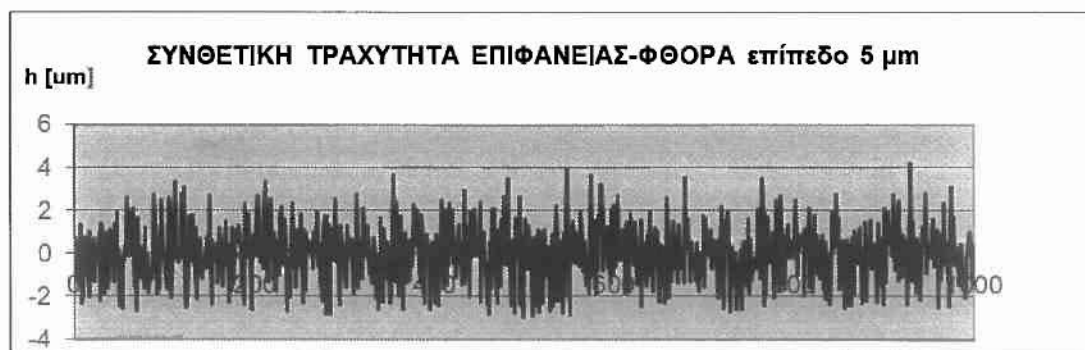
Σχήμα 3.2.4.1.: Γράφημα συνθετικής τραχύτητας σύμφωνα με το πρότυπο IV, προσομοίωση τραχείας επιφάνειας σε υψηλό επίπεδο κατωφλίου αποκοπής (επίπεδο φθοράς) \Delta w= 5 \mu\text{m} , στην περίπτωση αυτή χωρίς φθορά, τυπική απόκλιση \sigma=1,32 \mu\text{m} .
