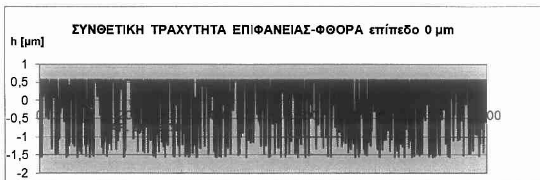
Σχήμα 3.2.3.4.: Γράφημα συνθετικής τραχύτητας σύμφωνα με το πρότυπο III, προσομοίωση τραχείας επιφάνειας σε επίπεδο κατωφλίου αποκοπής (επίπεδο φθοράς) \Delta w = 0 \mu\text{m} , τυπική απόκλιση \sigma = 0.76 \mu\text{m} .
