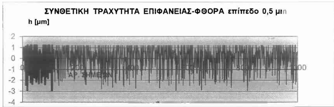
Σχήμα Π.2.4.11.: Κατατομή συνθετικής τραχύτητας (πρότυπο 4) για επίπεδο αποκοπής (φίλτρο φθοράς) w=0,5 \mu\text{m} .
