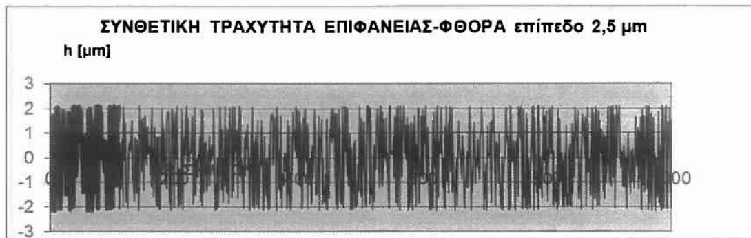
Σχήμα Π.2.3.1.: Κατατομή συνθετικής τραχύτητας (πρότυπο 3) για επίπεδο αποκοπής (φίλτρο φθοράς) w=2.5 \mu\text{m} , στην συγκεκριμένη περίπτωση αρχική κατάσταση χωρίς φθορά.
