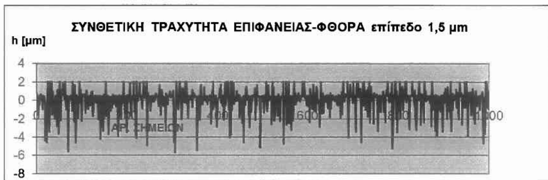
Σχήμα 1.2.1.: Ενδεικτική τραχυμέτρηση κατά μήκος του άξονα x.
