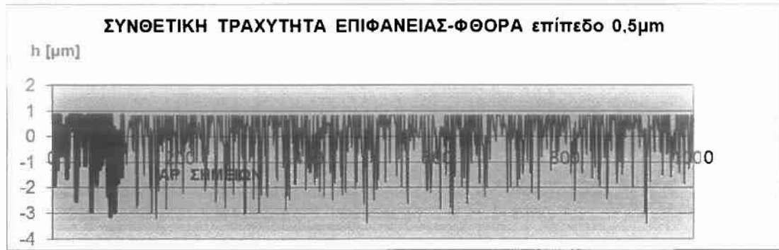
Σχήμα Π.2.1.15.: Κατατομή συνθετικής τραχύτητας (πρότυπο 1) για επίπεδο αποκοπής(φίλτρο φθοράς) w=0,5\mu\text{m} .
