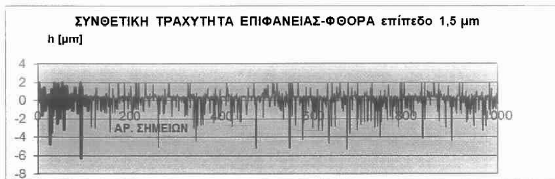
Σχήμα Π.2.5.3.: Κατατομή συνθετικής τραχύτητας (πρότυπο 5) για επίπεδο αποκοπής (φίλτρο φθοράς) w=1.5 \mu\text{m} .
