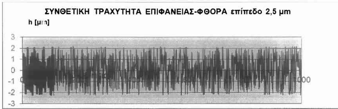
Σχήμα Π.2.2.3.: Κατατομή συνθετικής τραχύτητας (πρότυπο 2) για επίπεδο αποκοπής(φίλτρο φθοράς) w=2.5 \mu\text{m} .
