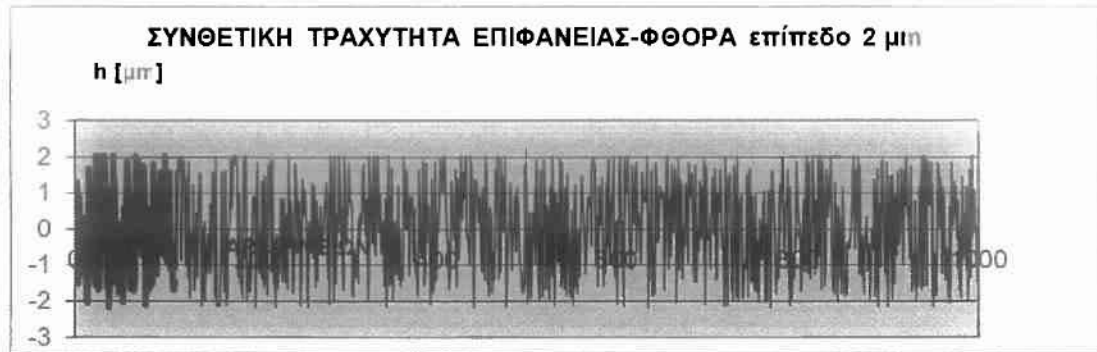
Σχήμα Π.2.2.5.: Κατατομή συνθετικής τραχύτητας (πρότυπο 2) για επίπεδο αποκοπής (φίλτρο φθοράς) w=2 μm.
