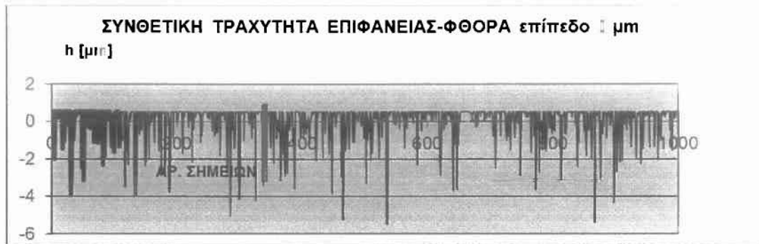
Σχήμα Π.2.5.9.: Κατατομή συνθετικής τραχύτητας (πρότυπο 5) για επίπεδο αποκοπής (φίλτρο φθοράς) w=0 \mu\text{m} .
