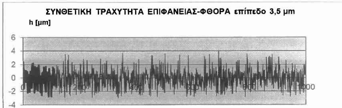
Σχήμα Π.2.4.1.: Κατατομή συνθετικής τραχύτητας (πρότυπο 4) για επίπεδο αποκοπής (φίλτρο φθοράς) w=3,5 \mu\text{m} , στην συγκεκριμένη περίπτωση αρχική κατάσταση χωρίς φθορά.
