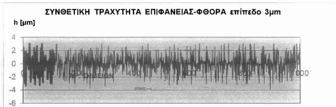
Σχήμα Π.2.1.7.: Κατατομή συνθετικής τραχύτητας (πρότυπο 1) για επίπεδο αποκοπής(φίλτρο φθοράς) w=3 \mu\text{m} .
