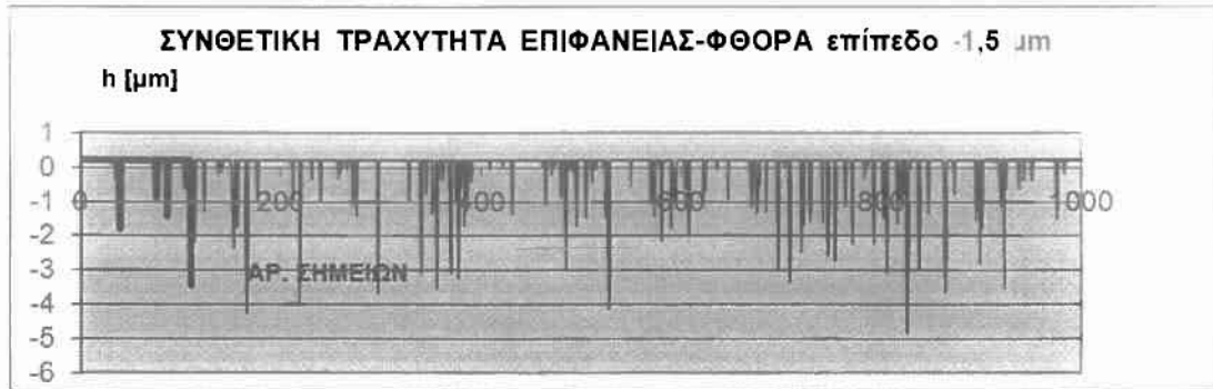
Σχήμα Π.2.5.15.: Κατατομή συνθετικής τραχύτητας (πρότυπο 5) για επίπεδο αποκοπής (φίλτρο φθοράς) w=-1.5 \mu\text{m} .
