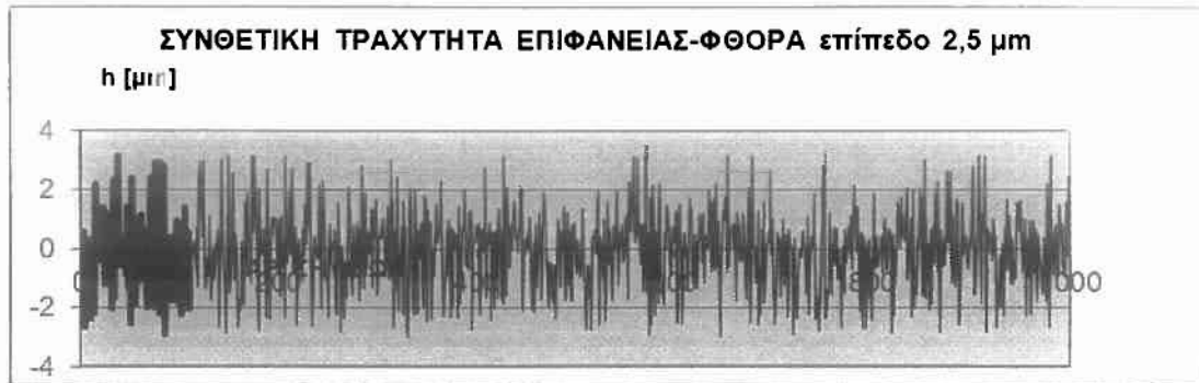
Σχήμα Π.2.4.5.: Κατατομή συνθετικής τραχύτητας (πρότυπο 4) για επίπεδο αποκοπής (φίλτρο φθοράς) w=2,5 \mu\text{m} .
