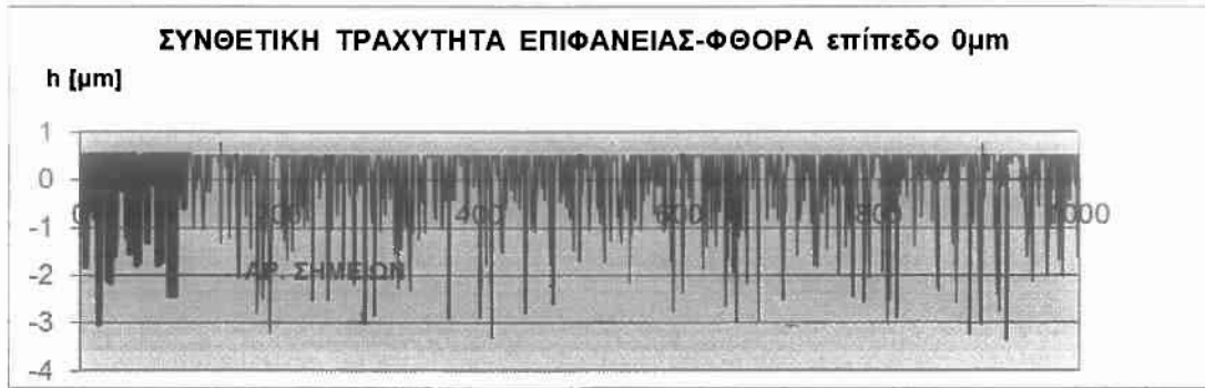
Σχήμα Π.2.1.17.: Κατατομή συνθετικής τραχύτητας (πρότυπο 1) για επίπεδο αποκοπής(φίλτρο φθοράς) w=0 \mu\text{m} .
