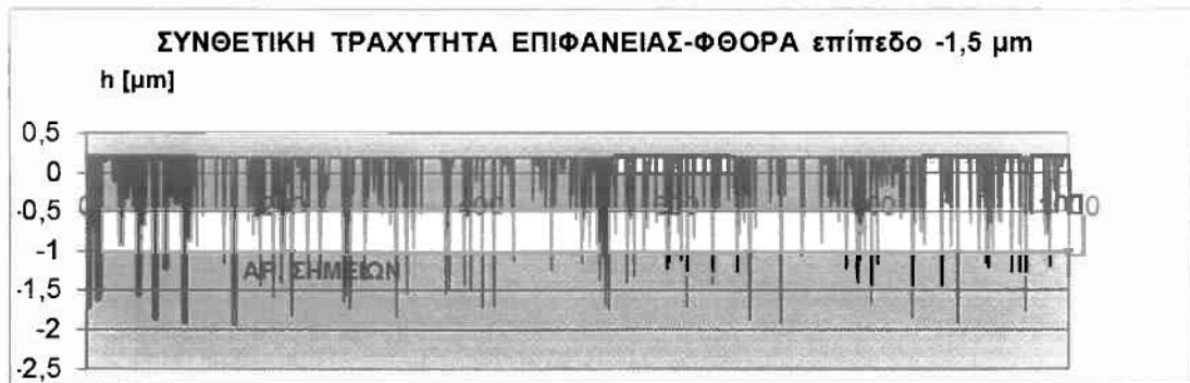
Σχήμα Π.2.4.19.: Κατατομή συνθετικής τραχύτητας (πρότυπο 4) για επίπεδο αποκοπής (φίλτρο φθοράς) w=-1,5 \mu\text{m} .
