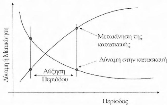
Σχήμα 1.2 Μεταβολή σεισμικής δύναμης και μετατόπισης λόγω σεισμού
