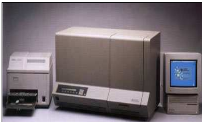
Εικόνα 26: Εξοπλισμός αλληλούχησης, ο οποίος περιλαμβάνει από αριστερά εκτυπωτή για το χρωματογράφημα, μηχάνημα ηλεκτροφόρησης με laser και ηλεκτρονικό υπολογιστή με κατάλληλο πρόγραμμα βιοπληροφορικής. ( http://www.bio.davidson.edu/Courses/Molbio/MolStudents/01licohen/sequencing.html )
