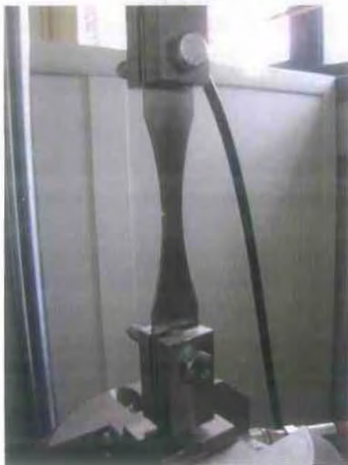
Εικόνα 4.7 Το δοκίμιο στην μηχανή εφελκυσμού
