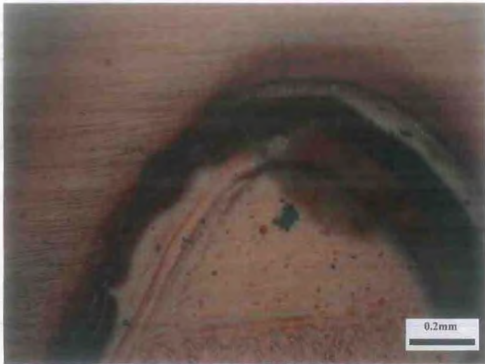
Εικόνα 5.15 Αποτύπωμα ρέπλικας του 5 ου δοκιμίου St 37 με εγκοπή στο ηλεκτρονικό μικροσκόπιο, μεγέθυνσης 100X μετά από 70.000 κύκλους, όπου φαίνεται πρώτη φορά η έναρξη της ρωγμής
