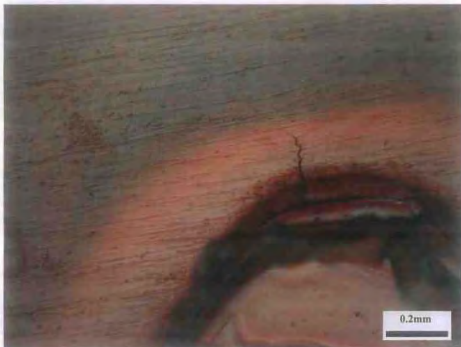
Εικόνα 5.16 Αποτύπωμα ρέπλικας του 5 ου δοκιμίου St 37 με εγκοπή στο ηλεκτρονικό μικροσκόπιο, μεγέθυνσης 100X μετά από 80.000 κύκλους, με την διάδοση της ρωγμής
