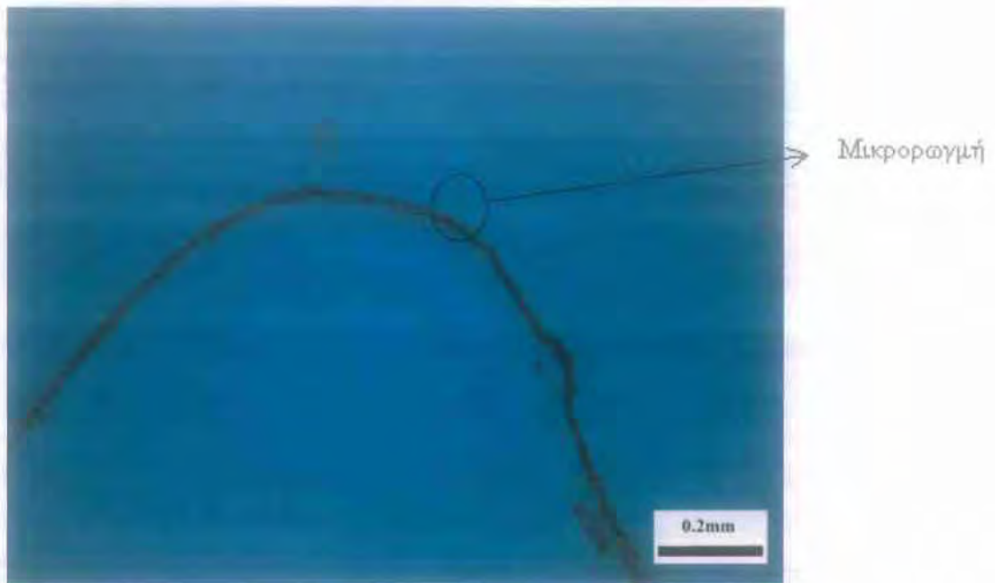
Εικόνα 5.11 Αποτύπωμα ρέπλικας του 6 ου δοκιμίου DP 500 με εγκοπή στο ηλεκτρονικό μικροσκόπιο, μεγέθυνσης 100X μετά από 110.000 κύκλους, όπου διακρίνεται η διάδοση του ρήγματος
