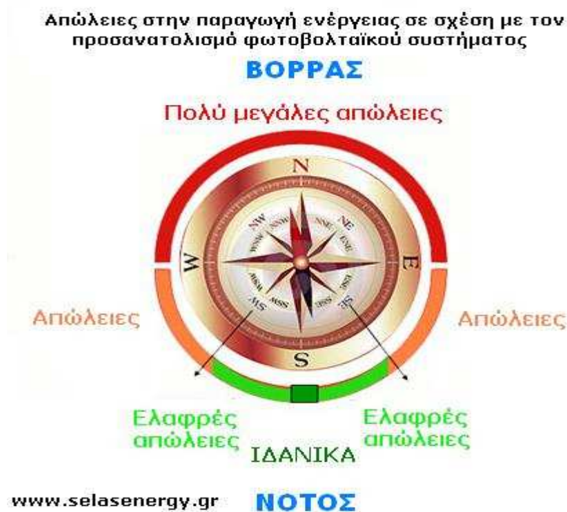
Εικόνα 4. Απώλειες στην παραγωγή ενέργειας σε σχέση με τον προσανατολισμό Φ/Β συστήματος
