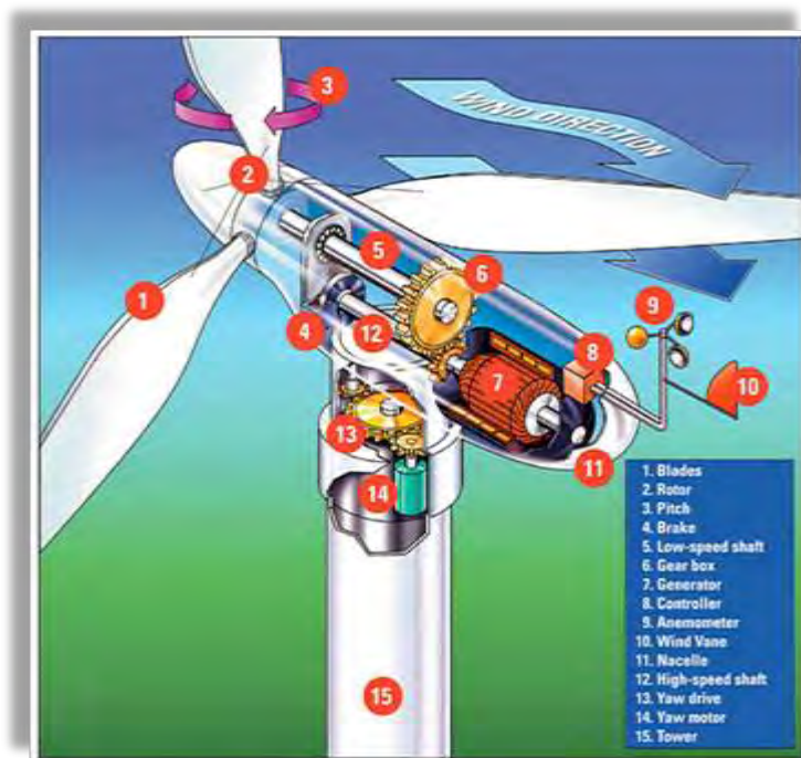
Εικόνα 9 : κατασκευαστικά στοιχεία τουρμπίνας
