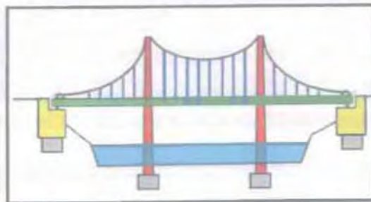
Σκαρίφημα κρεμαστής γέφυρας τριών ανοιγμάτων
